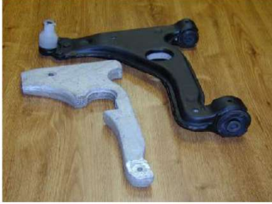
Resim 5.2. İçerisine Al köpük konularak desteklenmiş süspansiyon parçası [32]
