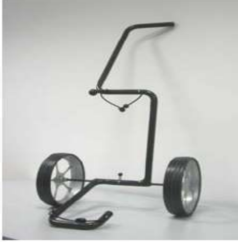
Resim 5.5. Eğimli parçaların içleri alüminyum köpük konularak desteklenmiş golf takımı taşıyıcısı [30]
