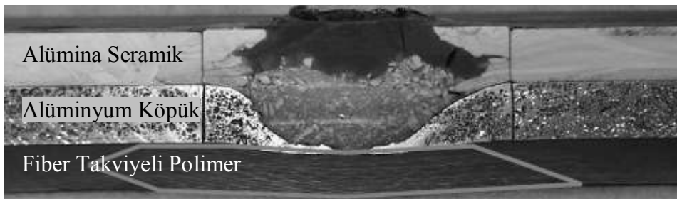
Resim 5.6. 20 mm'lik alüminyum köpük tabakası kullanılarak üretilen hafif zırh malzemesinin U.S. ordusu için balistik testi sonrası enine kesiti [41]
