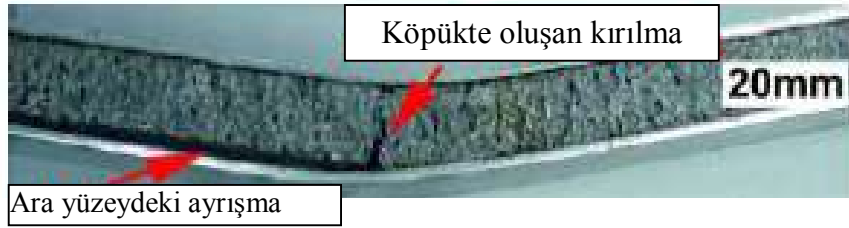
Resim 3.8. Yapay bağlanma ile üretilen sandviç köpüğün eğme testi sonrası görünümü [5]
