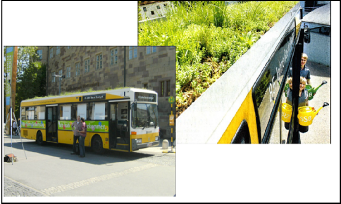
Resim 4.4.Yeşil çatı uygulamalarının yapıldığı toplu taşıma araçları [Reuter, 2010]
