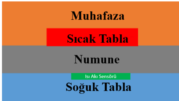
Şekil 4.18. Muhafazalı sıcak plaka yönteminin şematik görünümü [81]
