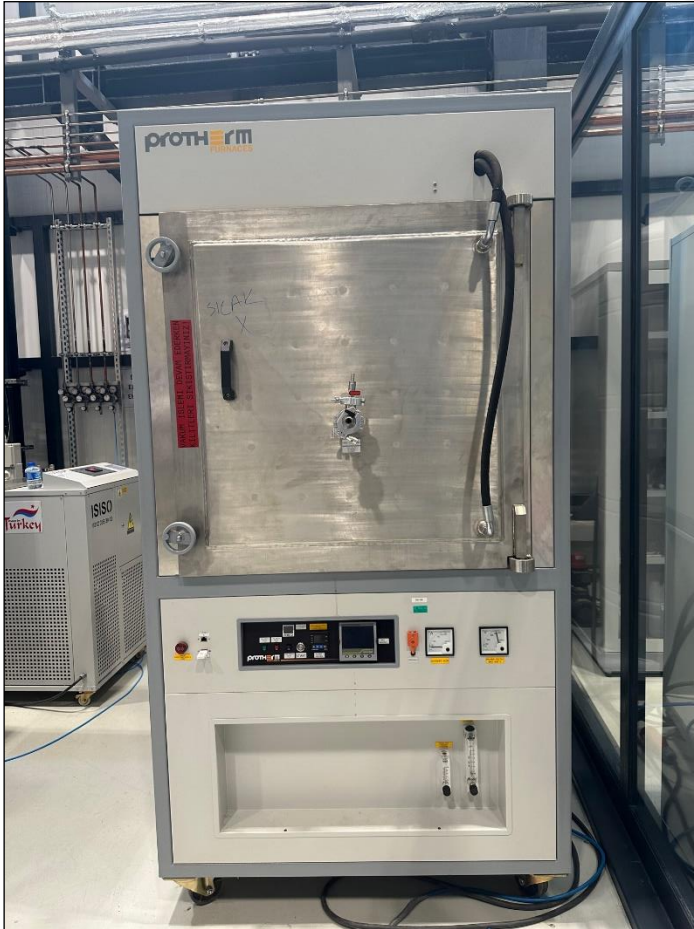
Şekil 4.12. Protherm ACF 13.55 Atmosfer Kontrollü Isıl İşlem Fırını
