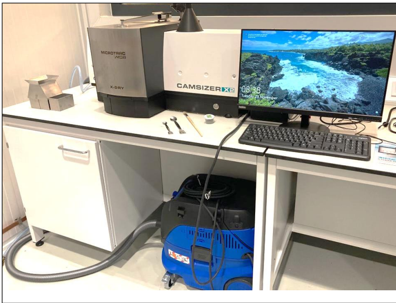
Şekil 4.17. Camsizer X2 model dinamik görüntü analizi ekipmanı
