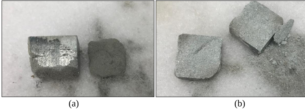
Şekil 5.2. (a) 400 MPa basınç, (b) 500 MPa basınç uygulanmış pres sonuçları
