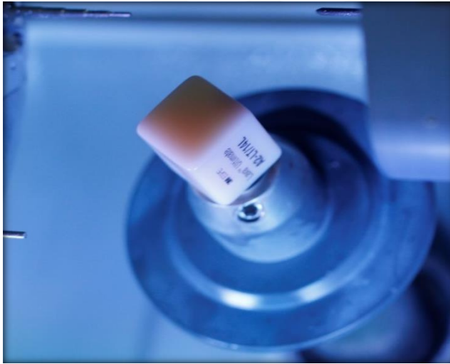
Resim 3.15. Restorasyonun frezleme ünitesindeki konumu
