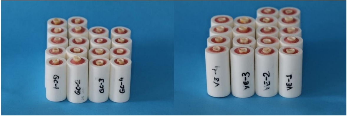
Resim 3.5. Her iki gruba ait örneklerin plastik boru içerisine akrilik rezin yardımı ile gömülmesi
