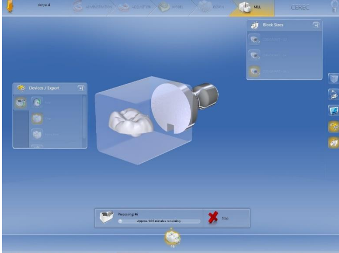
Resim 3.14. Restorasyonun blok içerisindeki konumu ve tij yolu
