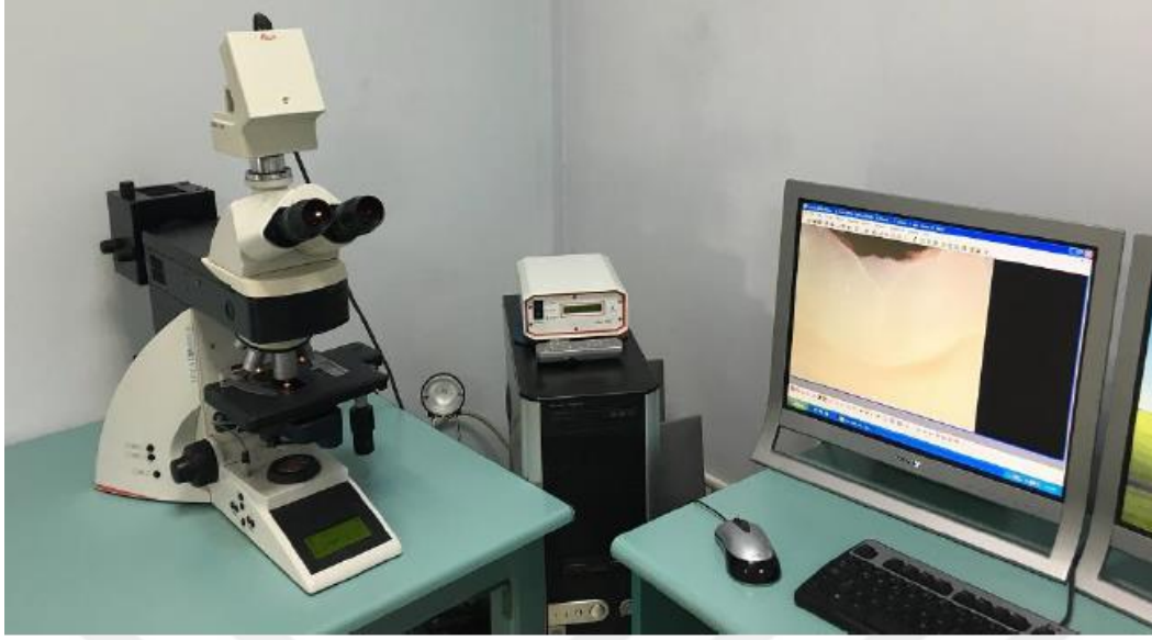
Resim 3.22. Aralık değerlerinin belirlenmesinde kullanılan mikroskop ve büyütme sistemi
