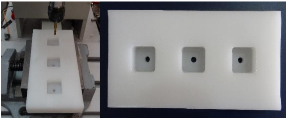
Resim 3.33. Polietilen kalıp ve torna cihazında hazırlanması
