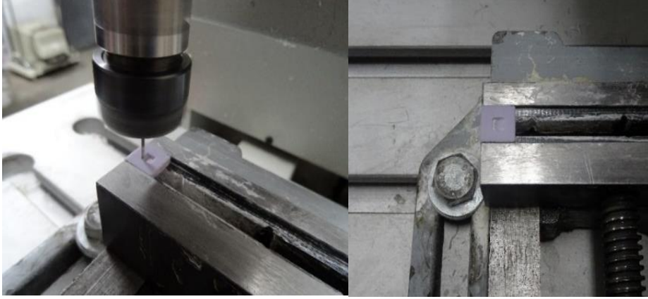
Resim 3.8. Lityum disilikat cam seramik CAD/CAM blok test örneklerinin merkezine torna cihazı kullanılarak kavite açılması
