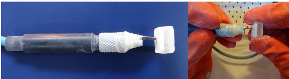
Resim 3.47. Örnek yüzeyi ile kumlama cihazının ucu arasındaki mesafenin her örnek için sabitlenmesi
