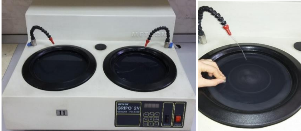
Resim 3.38. Aşındırma / polisaj cihazı ve örnek yüzeylerinin zımparalanması
