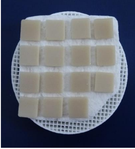
Resim 3.23. Zirkonya ile güçlendirilmiş lityum silikat cam seramik CAD/CAM blok test örneklerinin görünümü
