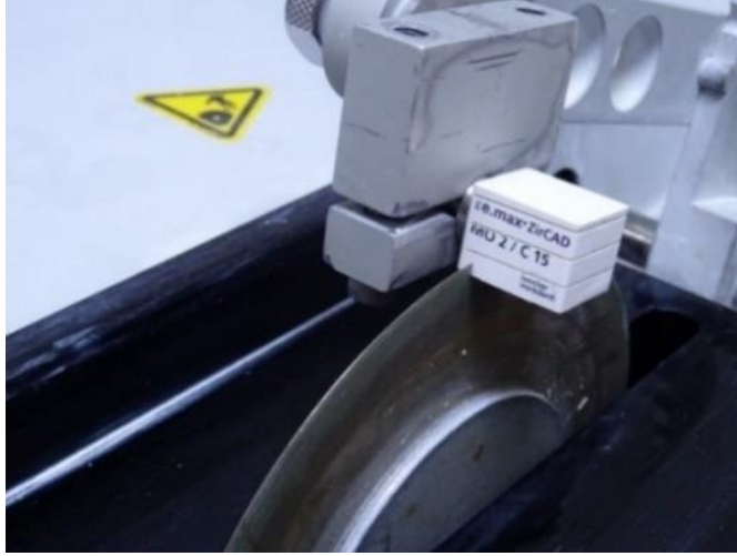
Resim 3.14. 15,5x15,5x3,75 mm boyutlarında dikdörtgenler prizması şeklinde itriyum ile stabilize zirkonyum oksit CAD/CAM blok örneklerin hazırlanması
