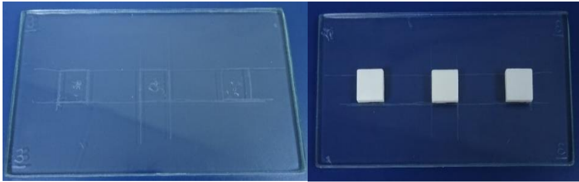
Resim 3.34. Cam üzerinde yapılan çizimler ve test örneklerinin cam üzerine sabitlenmesi
