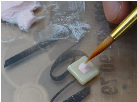
Resim 3.27. Hazırlanan kavitelere zirkonya ile güçlendirilmiş lityum silikat cam seramik CAD/CAM blok materyali ile uyumlu veneer materyali uygulanması
