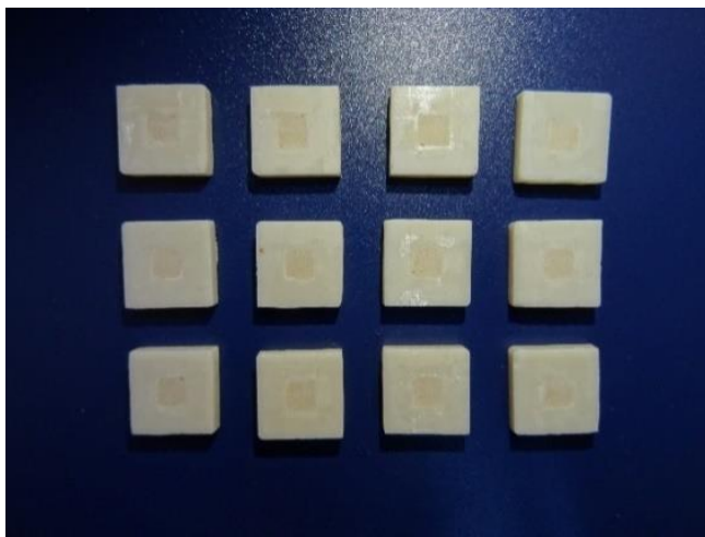
Resim 3.12. Düşük ısıda eriyen nano-florapatit cam seramik veneer materyali uygulanmış lityum disilikat cam seramik CAD/CAM blok test örnekleri
