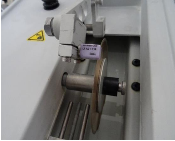
Resim 3.4. 3 mm'lik yatay kesitler alınarak 12x12x3 mm boyutlarında lityum disilikat cam seramik CAD/CAM blok örneklerin hazırlanması
