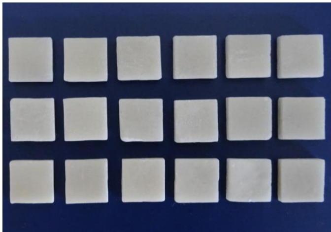
Resim 3.31. Veneer seramik test rneklerinin (VM11) fırınlama sonrası grnmleri
