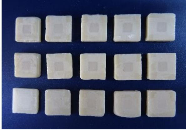
Resim 3.28. Veneer porseleni uygulanan zirkonya ile güçlendirilmiş lityum silikat cam seramik CAD/CAM blok örneklerin fırınlama sonrası görünüşleri
