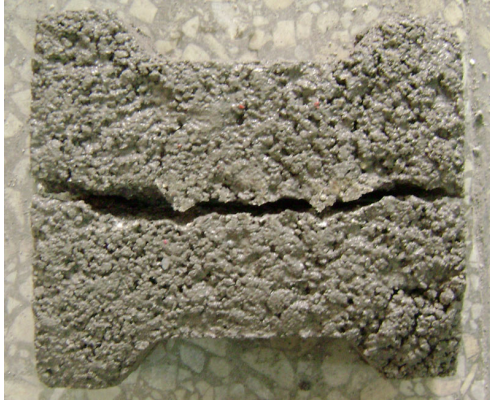
Resim 3.3 Yarmada çekme dayanımı deney sonucu kırılma.
