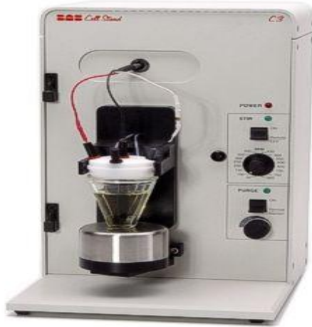
Resim 4.1. Elektrokimyasal çalışmalarda kullanılan çalışma ünitesi, potansiyostat ve elektrot standı.
