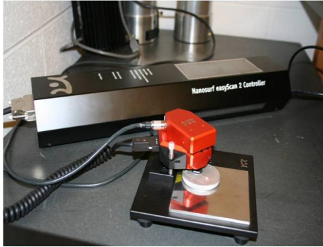
Resim 4.10. Grafen karakterizasyonu için kullanılan AFM ve SEM cihazları
