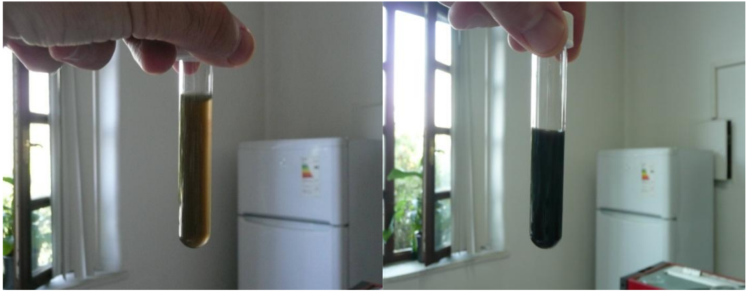
Resim 5.5. Grafen oksit (solda) ve grafene (sağda) ait fotoğraflar
