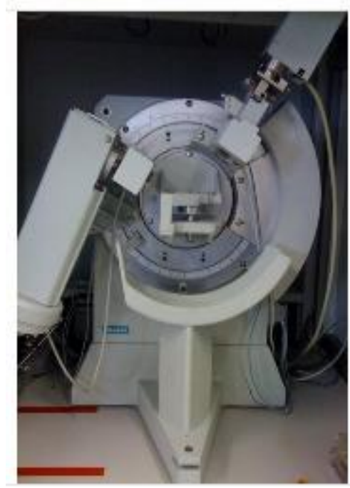
Resim 4.9 Grafen karakterizasyonu için kullanılan XRD ve Raman cihazı
