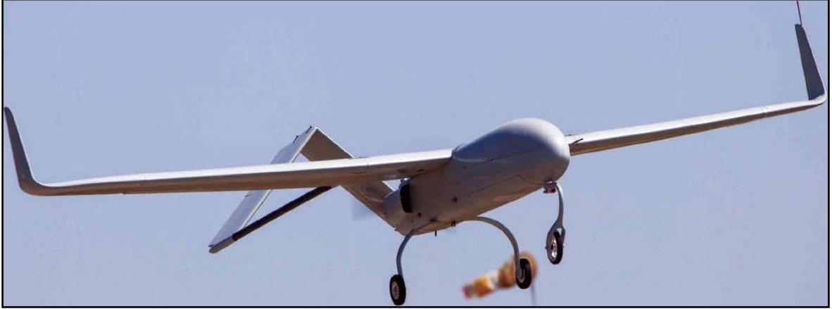
Şekil 4.4 İHA'larda Tek Parça Yaprak Yay
