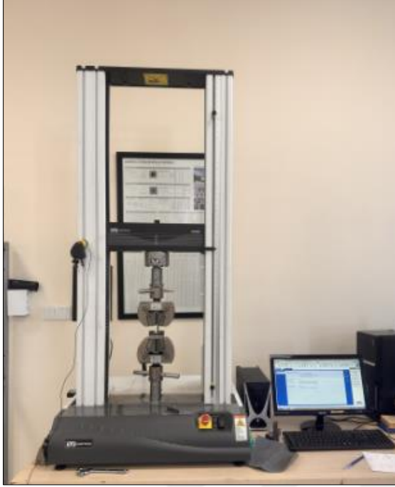
Resim 4.5. Instron 3369 model üç nokta eğme testi cihazı
