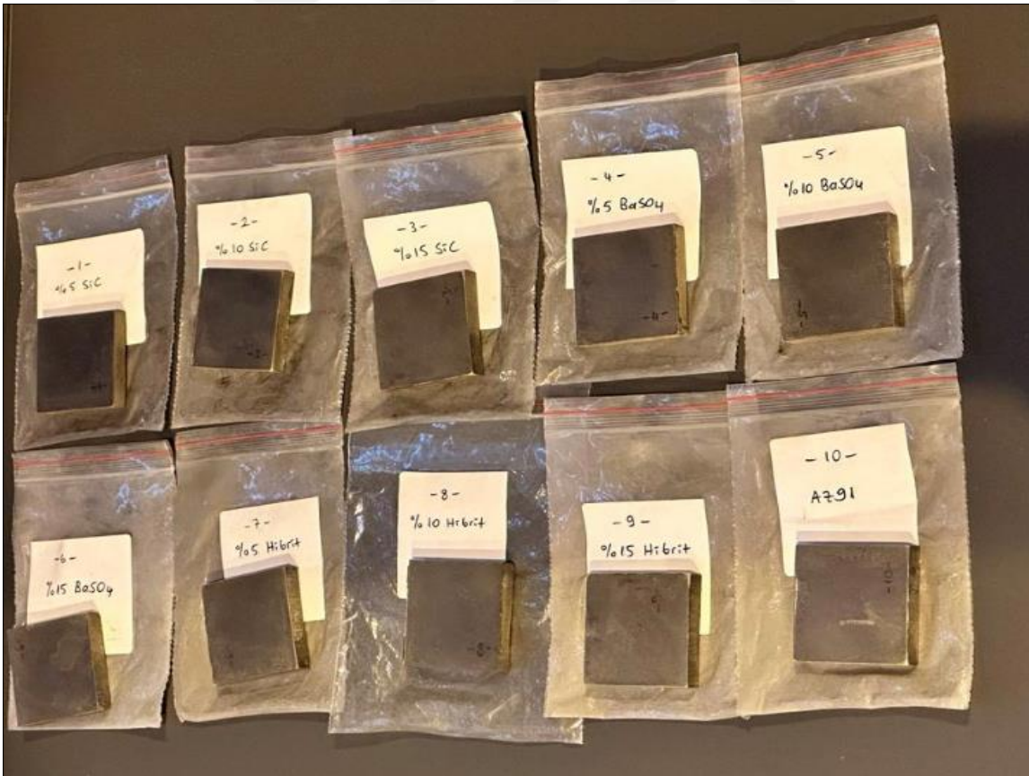
Resim 4.3. Sıcak pres yöntemi ile üretilen kompozit numuneler
