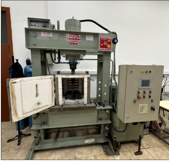
Resim 4.2. 160 ton kapasiteli hidrolik pres cihazı
