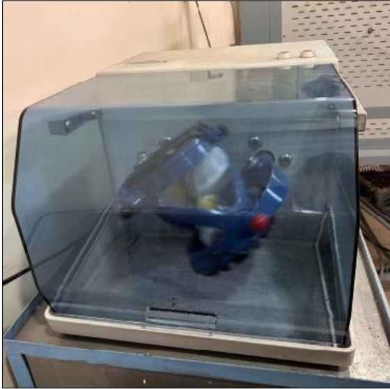
Resim 4.1. Turbola marka üç boyutlu karıştırıcı
