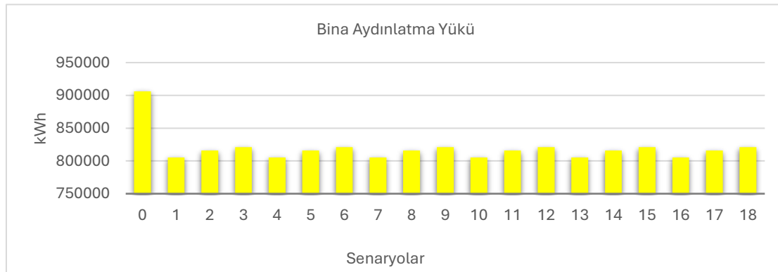
Şekil 5.1. Bina yıllık aydınlatma enerjisi ihtiyacı
