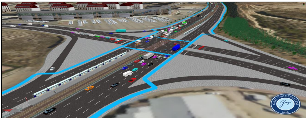
Şekil 5.269. 4 Numaralı kavşağın alternatif 5 %15 artırılmış sayımlar akşam simülasyonu
