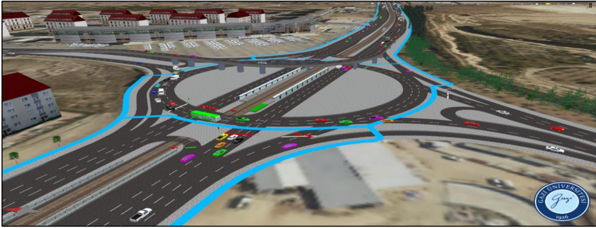
Şekil 5.187. 4 Numaralı kavşağın alternatif 4 mevcut sayımlar sabah simülasyonu
