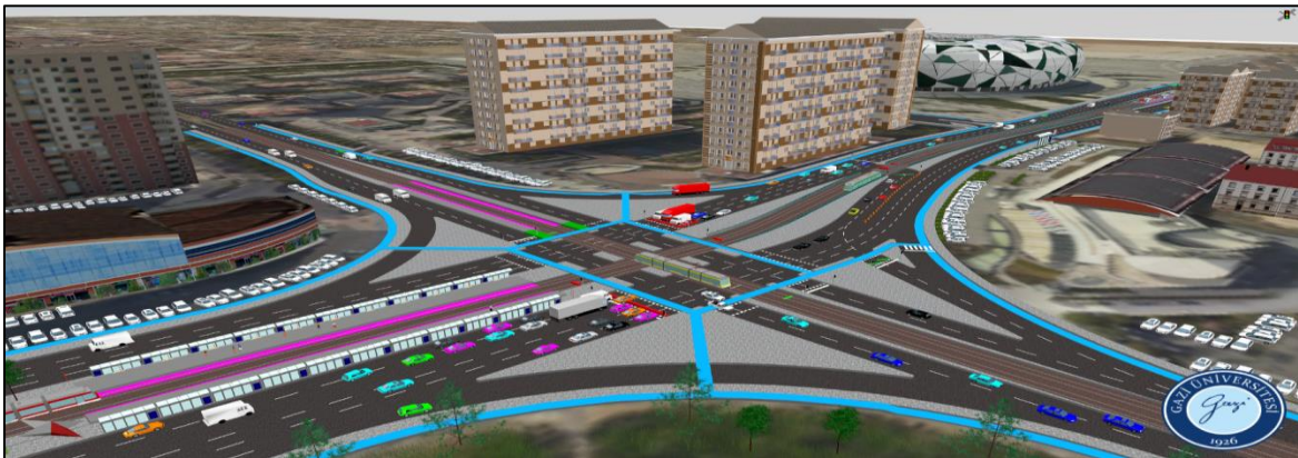
Şekil 5.192. 1 Numaralı kavşağın alternatif 4 %5 artırılmış sayımlar akşam simülasyonu
