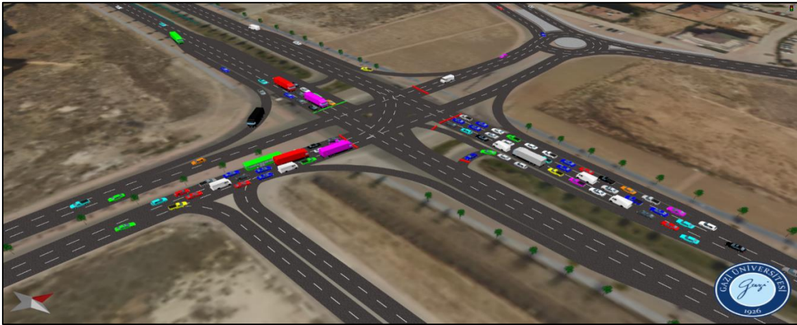
Şekil 5.10. 5 Numaralı kavşağın mevcut durum akşam simülasyon modeli
