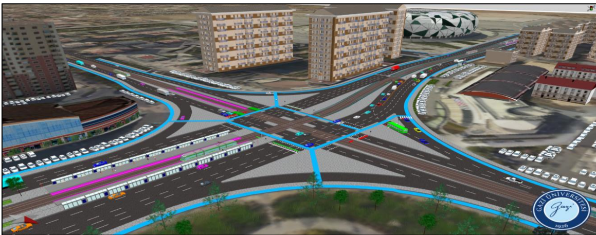
Şekil 5.182. 1 Numaralı kavşağın alternatif 4 mevcut sayımlar akşam simülasyonu
