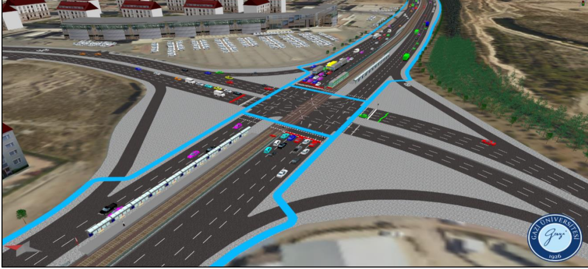
Şekil 5.49. 4 Numaralı kavşağın alternatif 1 %10 artırılmış sayımlar akşam simülasyonu
