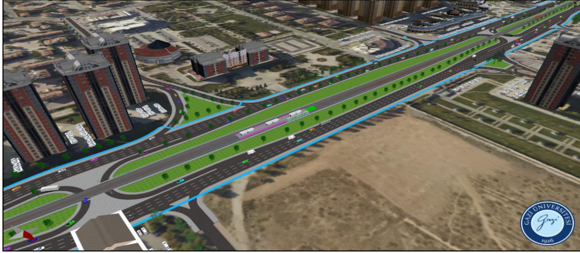
Şekil 5.44. 2 Numaralı kavşağın alternatif 1 %10 artırılmış sayımlar sabah simülasyonu
