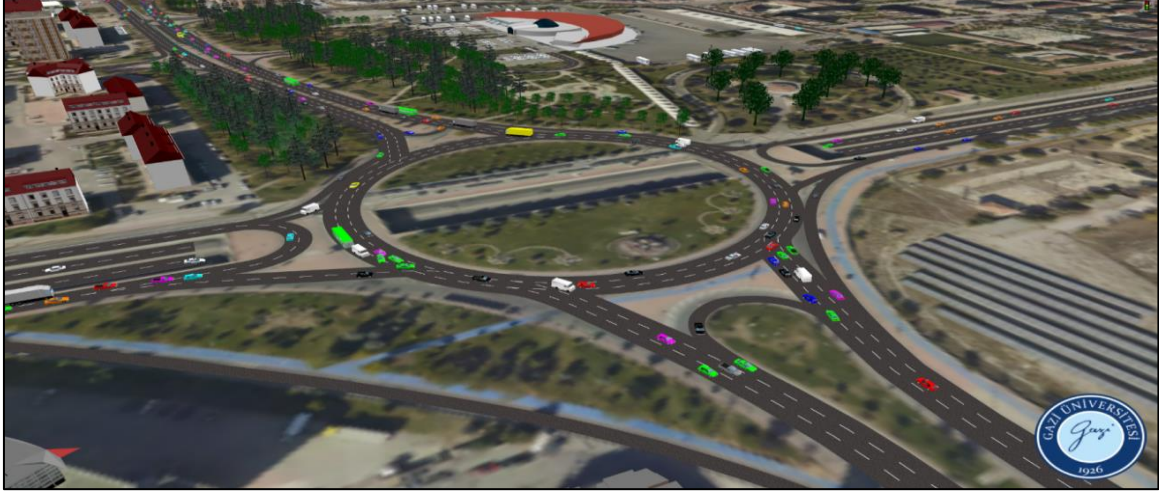
Şekil 5.6. 3 Numaralı kavşağın mevcut durum akşam simülasyon modeli
