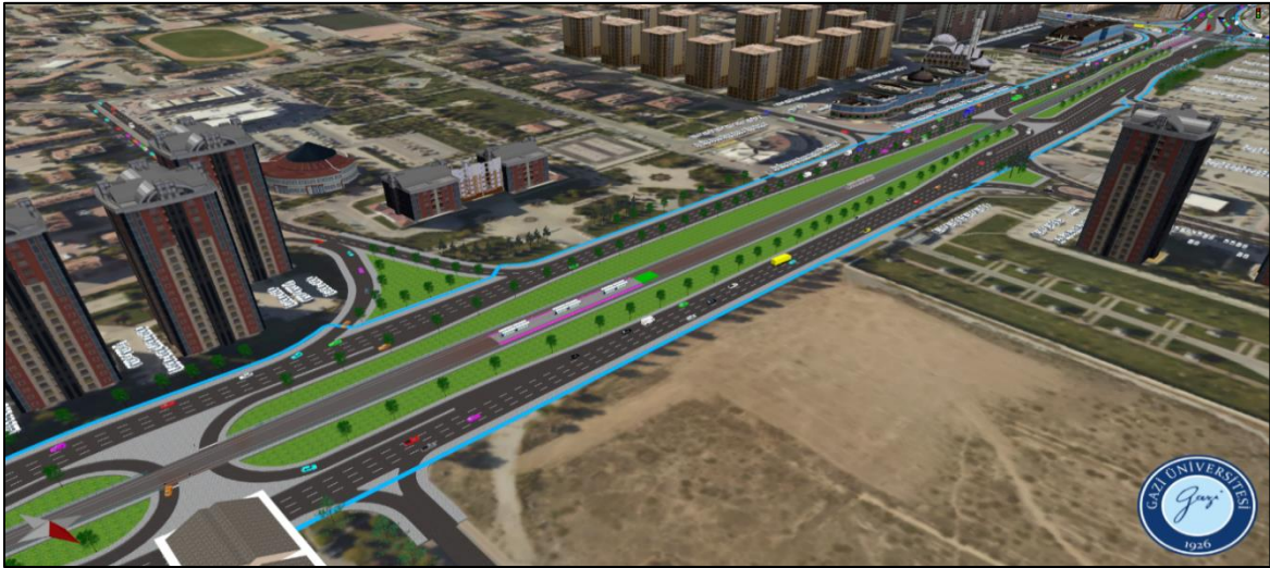
Şekil 5.54. 2 Numaralı kavşağın alternatif 1 %15 artırılmış sayımlar sabah simülasyonu
