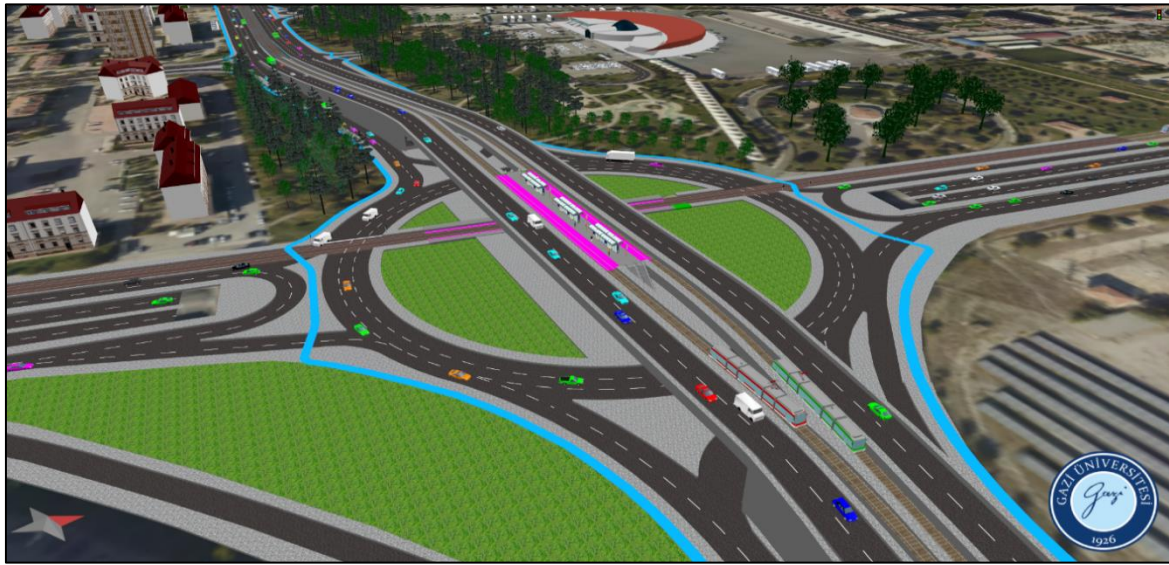
Şekil 5.66. 3 Numaralı kavşağın alternatif 1 %20 artırılmış sayımlar sabah simülasyonu
