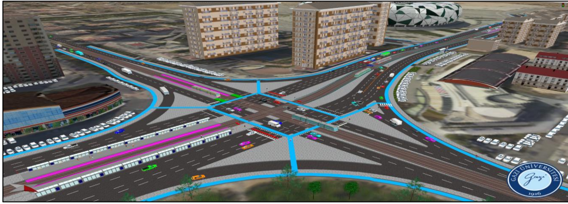
Şekil 5.221. 1 Numaralı kavşağın alternatif 4 %20 artırılmış sayımlar sabah simülasyonu
