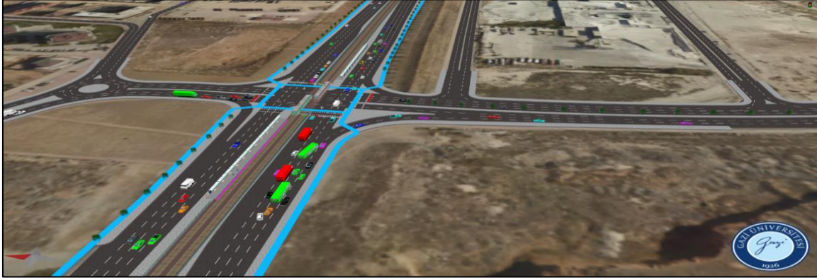
Şekil 5.250. 5 Numaralı kavşağın alternatif 5 %5 artırılmış sayımlar sabah simülasyonu
