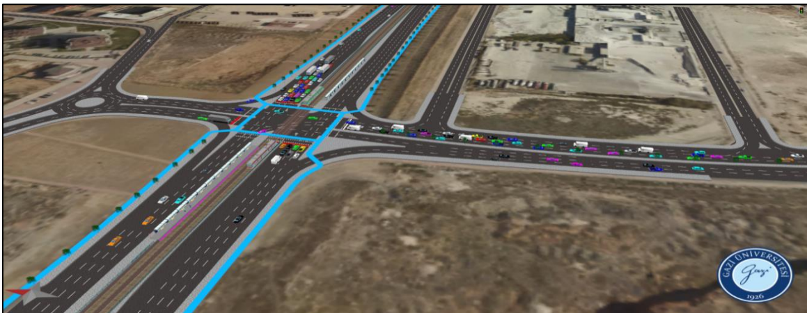
Şekil 5.281. 5 Numaralı kavşağın alternatif 5 %20 artırılmış sayımlar akşam simülasyonu
