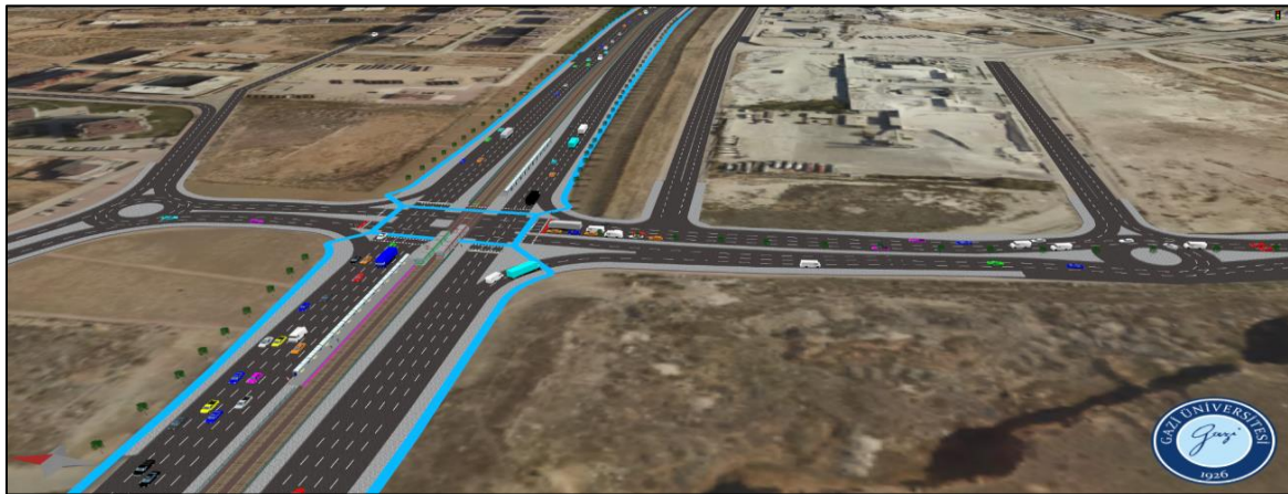
Şekil 5.137. 5 Numaralı kavşağın alternatif 3 mevcut sayımlar akşam simülasyonu
