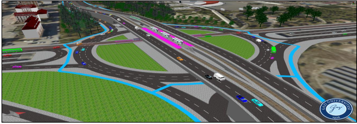
Şekil 5.109. 3 Numaralı kavşağın alternatif 2 %15 artırılmış sayımlar sabah simülasyonu
