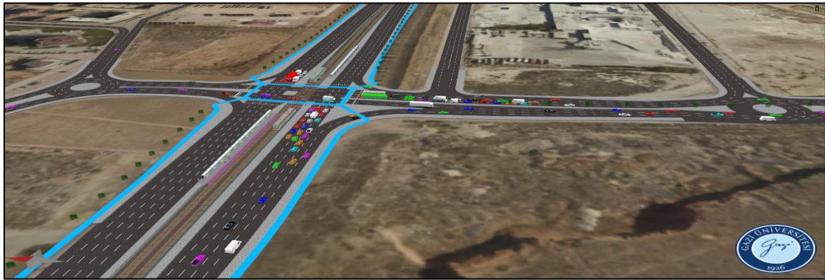
Şekil 5.229. 5 Numaralı kavşağın alternatif 4 %20 artırılmış sayımlar sabah simülasyonu
