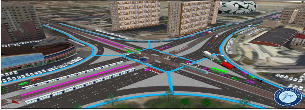
Şekil 5.252. 1 Numaralı kavşağın alternatif 5 %10 artırılmış sayımlar sabah simülasyonu
