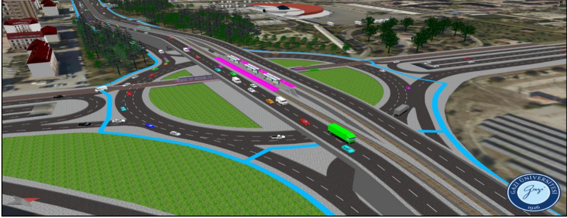
Şekil 5.79. 3 Numaralı kavşağın alternatif 2 mevcut sayımlar sabah simülasyonu
