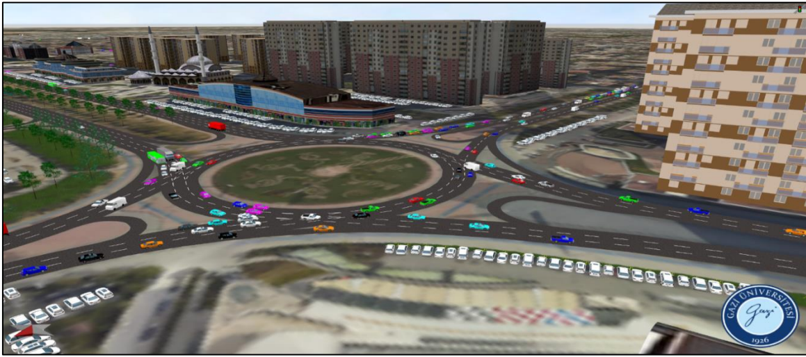
Şekil 5.1. 1 Numaralı kavşağın mevcut durum sabah simülasyon modeli
