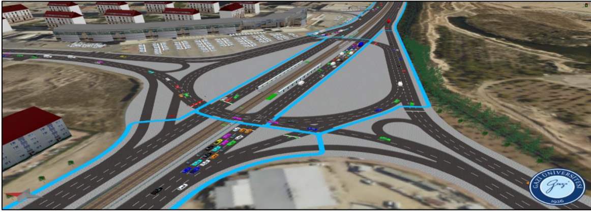
Şekil 5.134. 4 Numaralı kavşağın alternatif 3 mevcut sayımlar sabah simülasyonu
