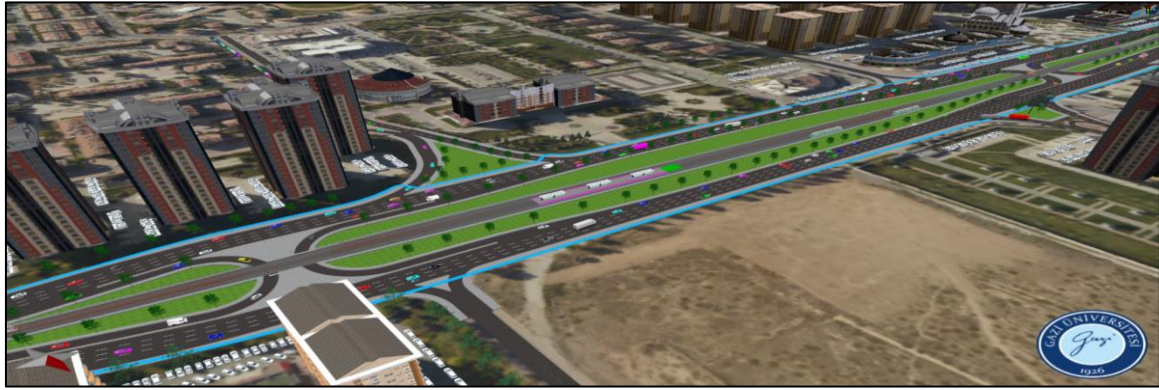
Şekil 5.244. 2 Numaralı kavşağın alternatif 5 %5 artırılmış sayımlar sabah simülasyonu
