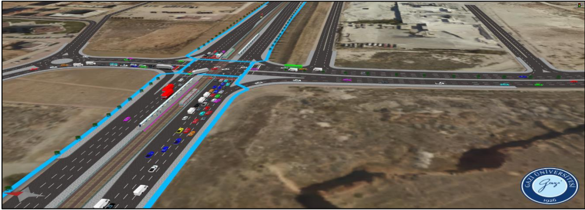
Şekil 5.280. 5 Numaralı kavşağın alternatif 5 %20 artırılmış sayımlar sabah simülasyonu
