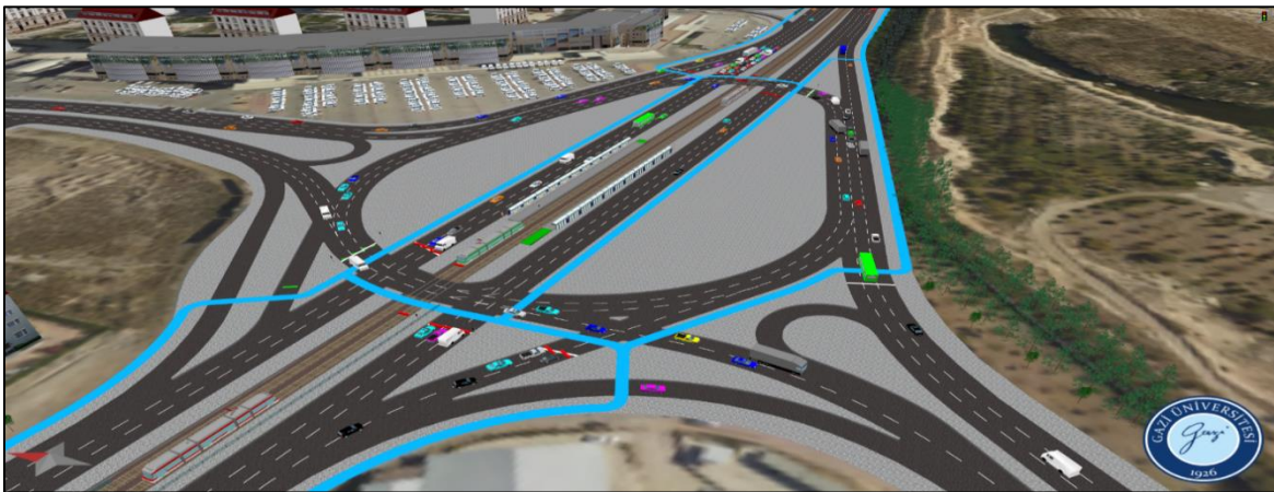
Şekil 5.82. 4 Numaralı kavşağın alternatif 2 mevcut sayımlar akşam simülasyonu
