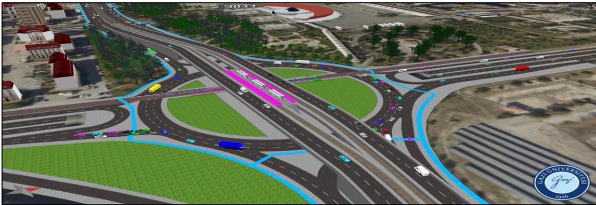
Şekil 5.196. 3 Numaralı kavşağın alternatif 4 %5 artırılmış sayımlar akşam simülasyonu
