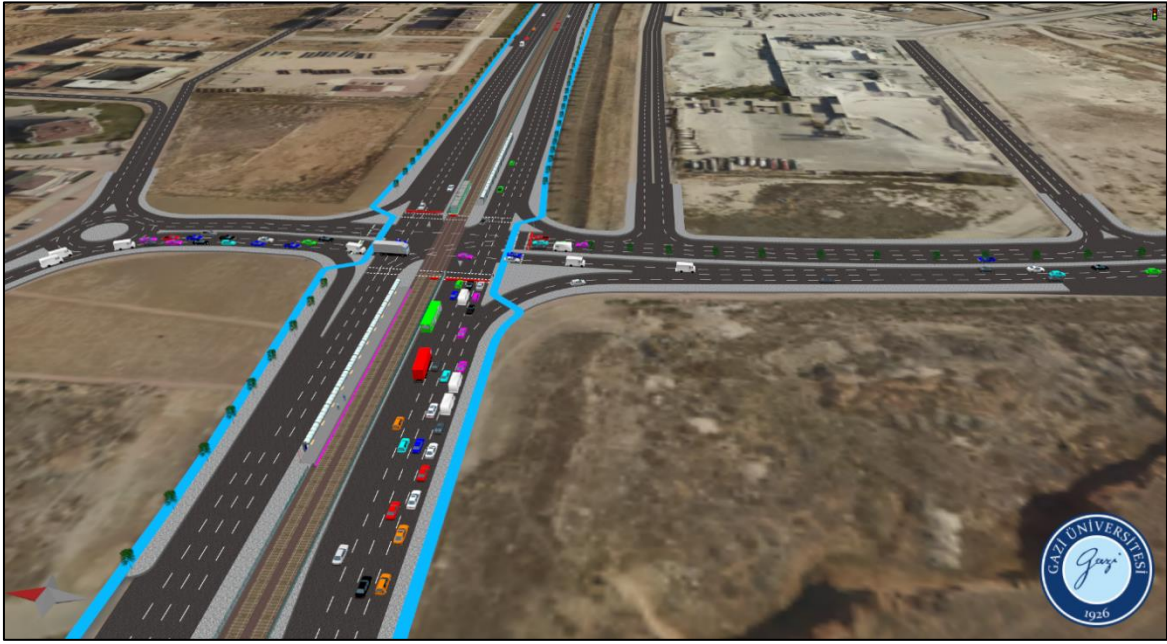
Şekil 5.30. 5 Numaralı kavşağın alternatif 1 mevcut sayımlar sabah simülasyonu
