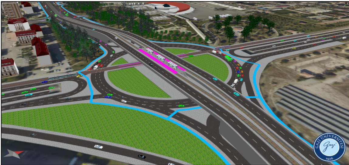
Şekil 5.37. 3 Numaralı kavşağın alternatif 1 %5 artırılmış sayımlar akşam simülasyonu
