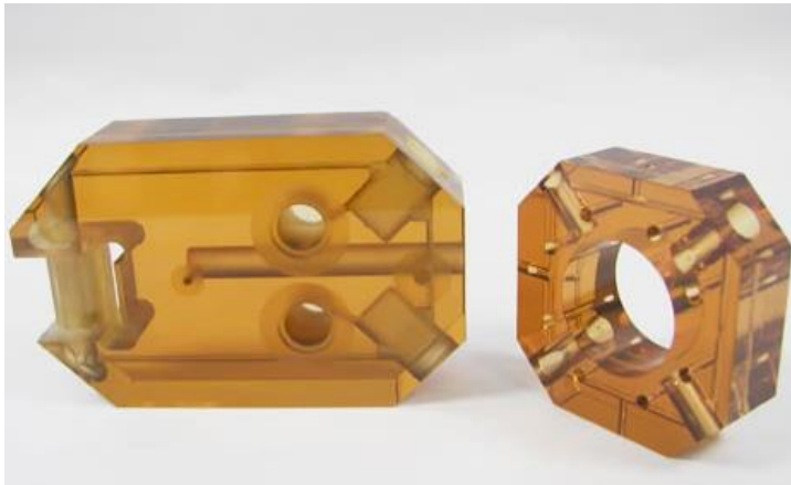
Resim 2.7. AstroSital® cam seramik malzemenin çeşitli uygulamalar için şekillendirilmiş hali
