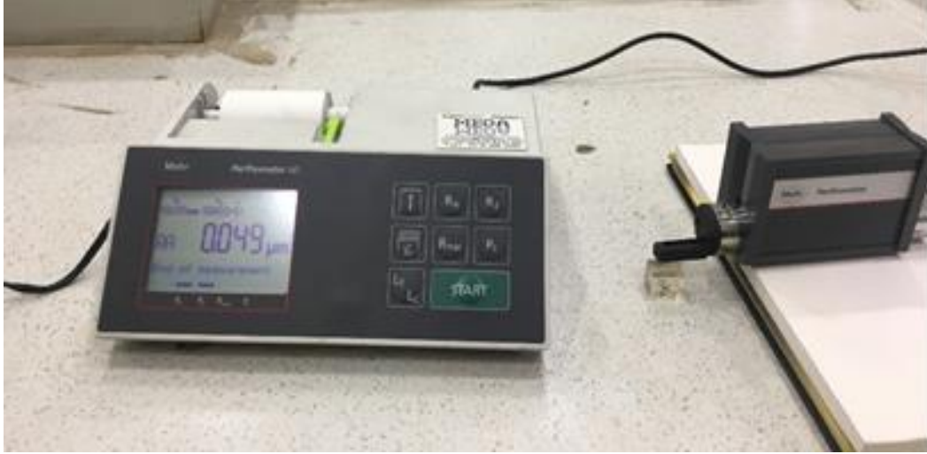
Resim 5.18. Mahr marka Perthometer M1 profilometresi
