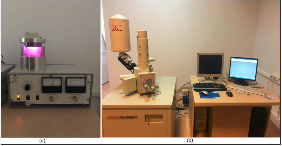
Resim 5.19. (a) Numunelerin kaplanma işlemi (b) taramalı elektron mikroskobu
