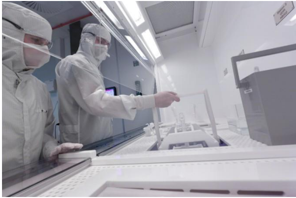
Resim 5.6. Kimyasal aşındırma operasyonunda kullanılan taşmalı küvetli ıslak tezgahlar
