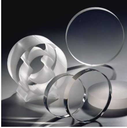
Resim 2.4. ULE® camlar ve çeşitli uygulamalar için işlenmiş hali [14]
