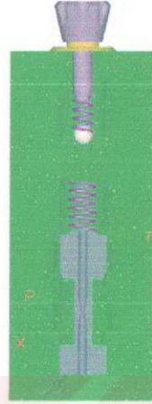
Şekil 3.36. Pilot kontrollü emniyet valfi
