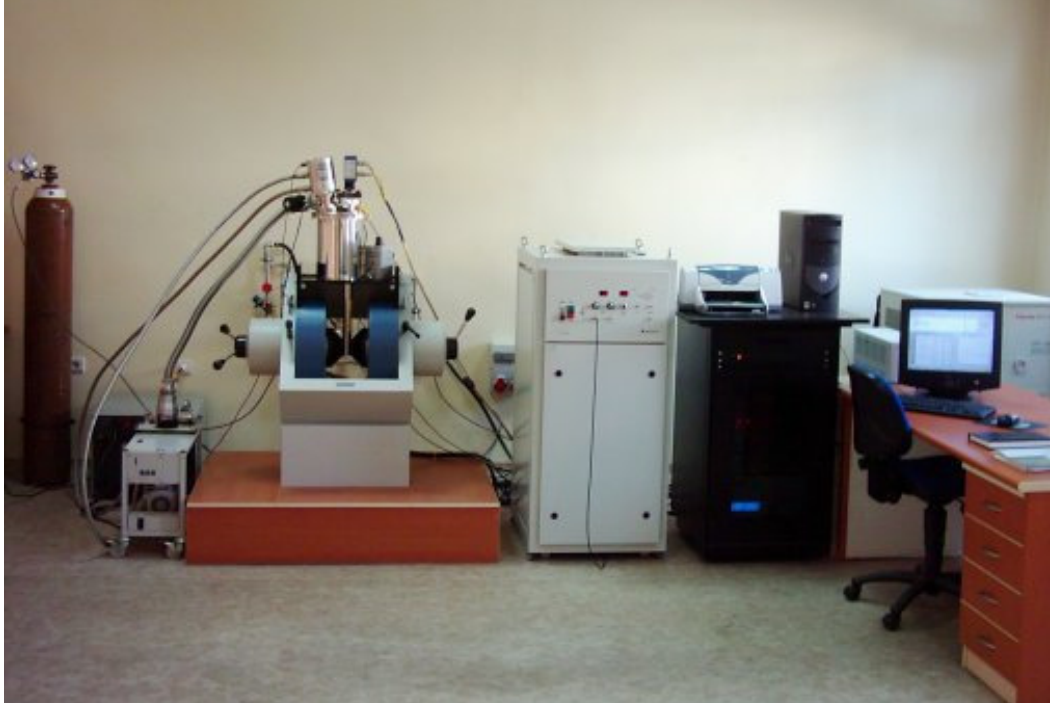
Resim 4.4. Lakeshore 7700 serisi Yüksek Empedans Hall etkisi ölçüm sistemi
