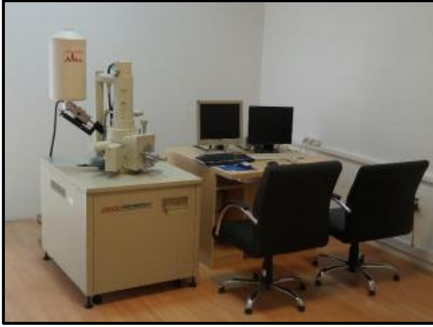
Resim 7.8. Jeol marka JSM-6060LV modeli taramalı elektron mikroskobu
