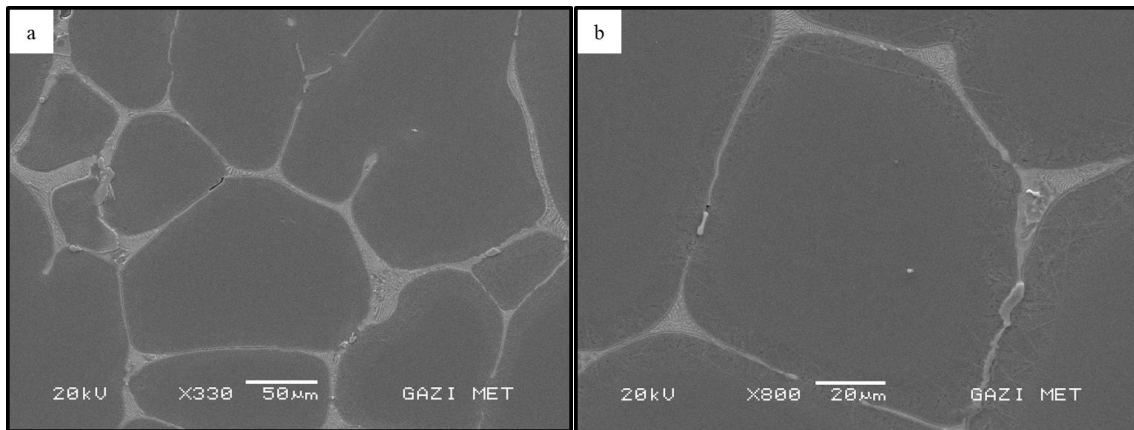
Resim 8.8. AA7050 Al alaşımının 50Hz tiktotropik özellikteki numunenin SEM görüntüleri; a. 330X, b. 800X
