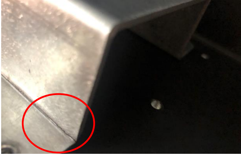
Resim 2.10. X eksenı titreřim testi sonucu atlak ilerlemesi
