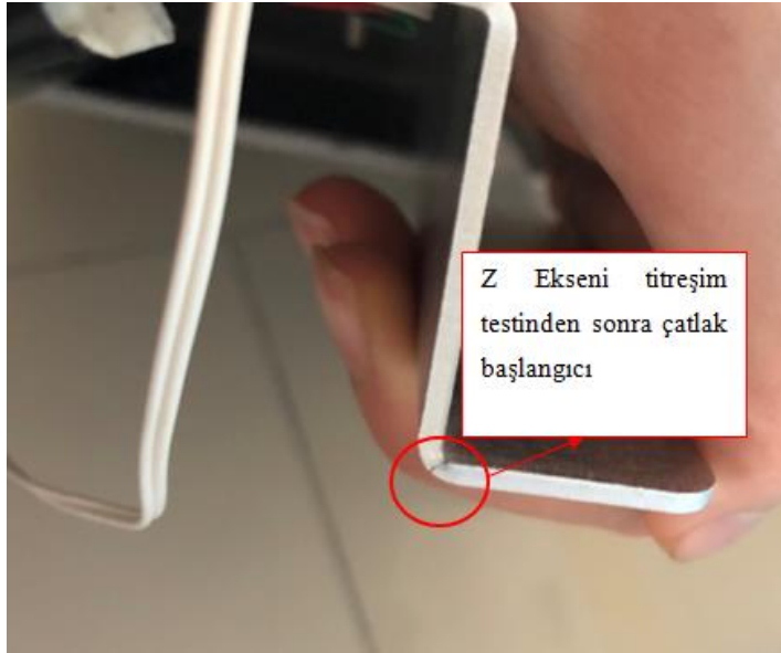
Resim 2.7. Test sonucu braketten oluşan çatlak başlangıcı
