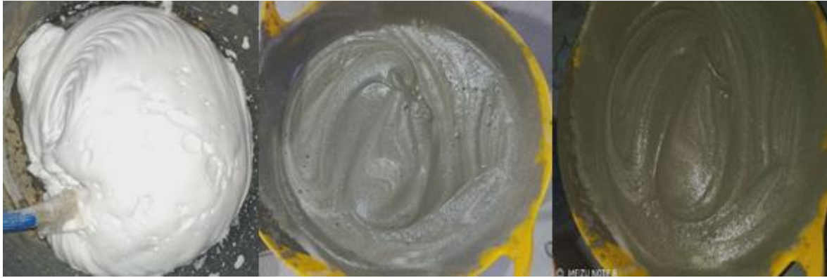
Resim 2.1. Köpük görünümü ve köpük beton harcı (Özçelik, 2022)
