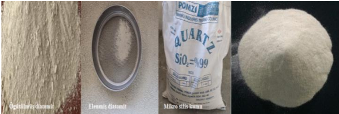
Resim 3.1. Araştırmada kullanılan diatomit ve silis kumu
