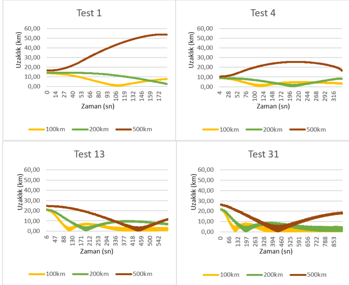
Şekil 7.2. D_u mesafesinin 100km, 200km ve 500km olduğu karşılama modellerinin farklı saldırı senaryolarındaki güzergâh takip performansları
