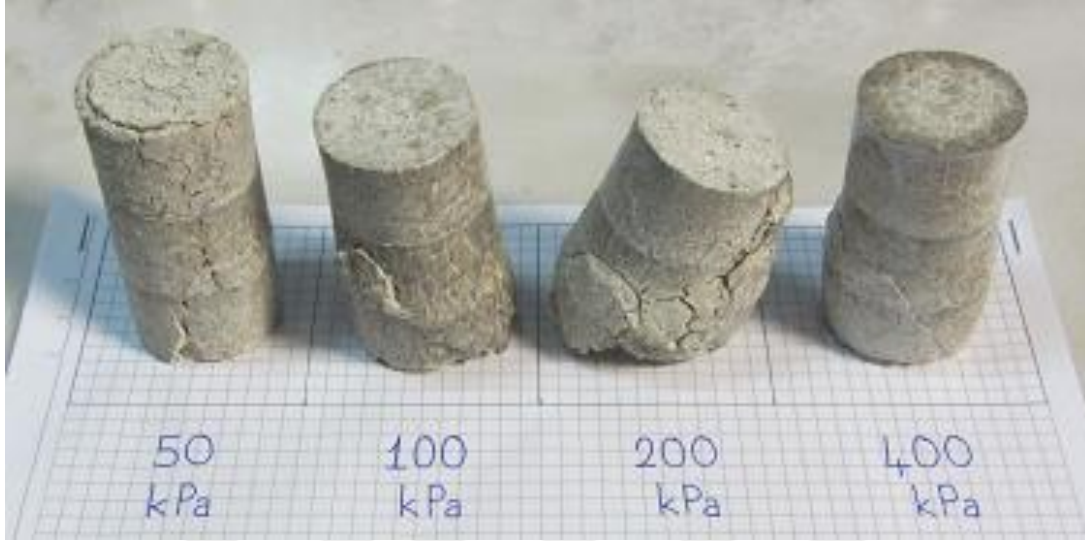
EK-27. MPE düzeyinde sıkıştırılmış numunelerde UU (doymadan) deney sonu fotoğrafları (A, B ve C numuneleri)
