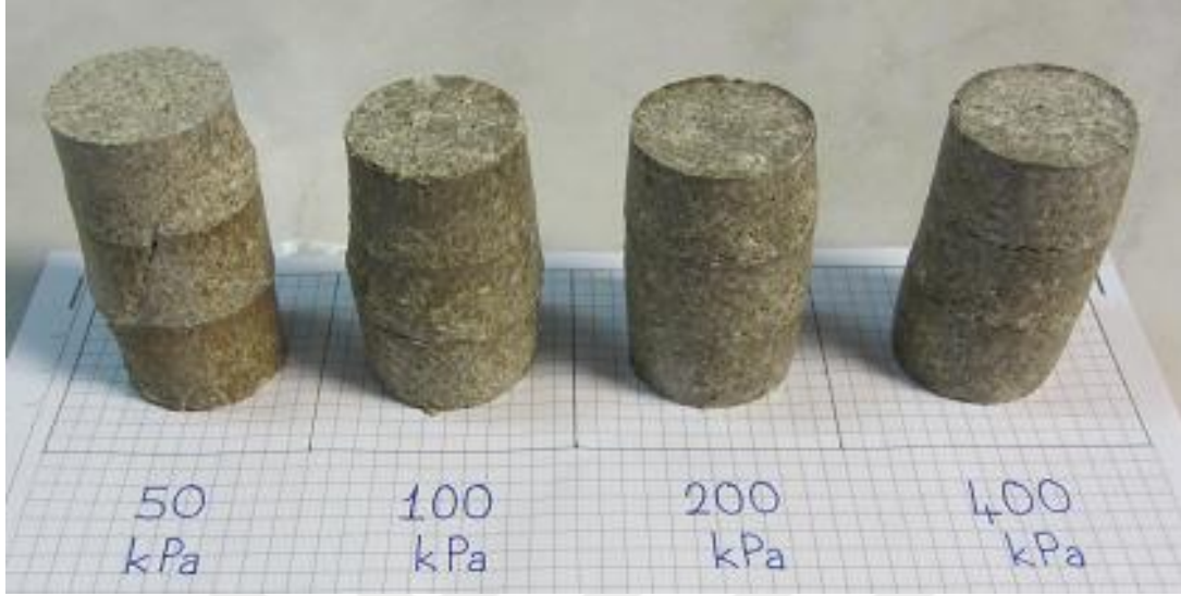
EK-20. SPE düzeyinde sıkıştırılmış numunelerde UU (doyurmadan) deney sonu fotoğrafları (D, E ve F numuneleri)
