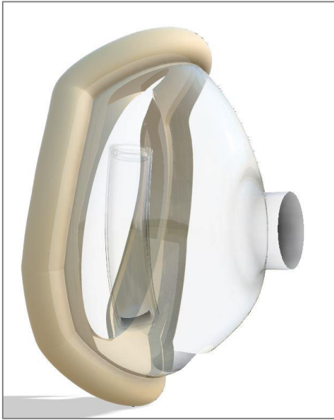
Şekil 5.18. Hava yastığı grubu ve ana gövde montajı
