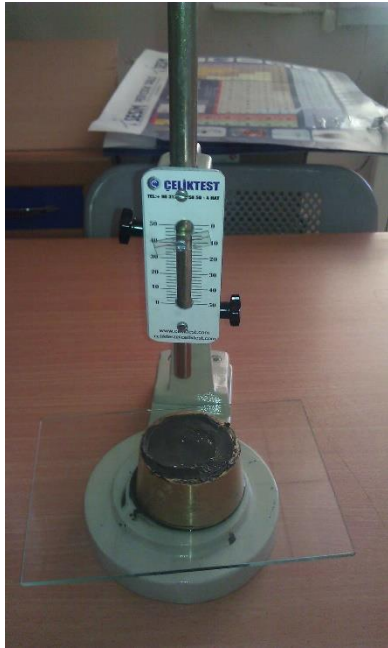
Resim 6.7. Vicat sondası ile normal kıvam suyu tayini
