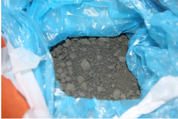
Resim 6.2. Deneylerde kullanılan klinker numunesi
