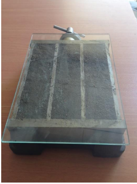
Resim 6.10. Çimento harcının kalıplanması
