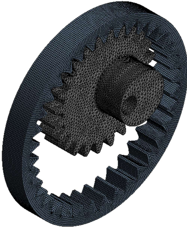
Şekil 5.18. Scotch yoke ve episiklik dişli mekanizmalı özgün Atkinson motorunda kullanılan pinyon ve iç dişlinin sonlu elemanlar modeli
