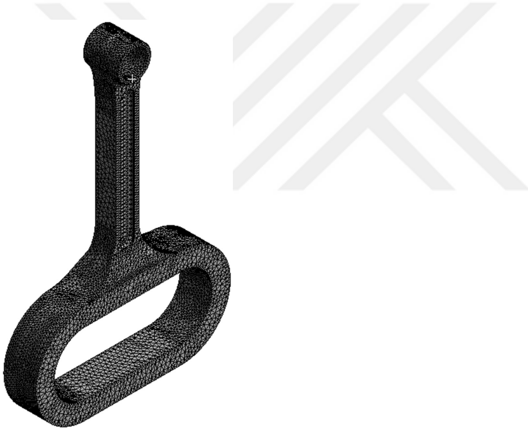
Şekil 5.11. Scotch yoke ve episiklik dişli mekanizmalı özgün Atkinson motorunda kullanılan biyelin sonlu elemanlar modeli
