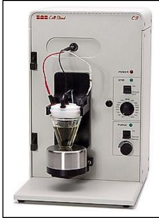
Şekil 3.1. Kaplama ve ölçümde kullanılan BAS C3 hücre sistemi
