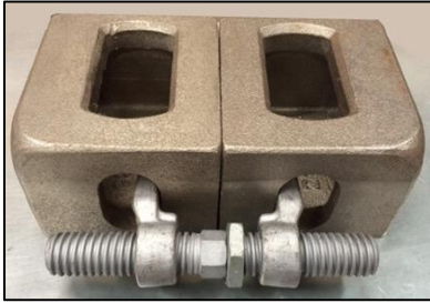
Resim 2.8. Konteyner birimlerin yan yana montajında manşon kullanılması (Url-26)
