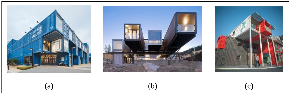
Resim 2.7. Konteyner birimlerin birbirine montajında kullanılan sistemler: yığma sistem (a) (Url-23), iskelet taşıyıcıya monte sistem (b) (Url-24), karma sistem (c) (Url-25)
