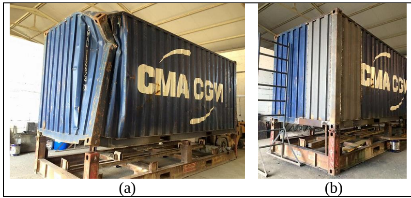
Resim 2.14. Mekanik ve yapısal testler sonucunda konteyner birimlere onarım yapılması (Url-35): hasarlı konteyner birim (a), onarılmış konteyner birim (b)
