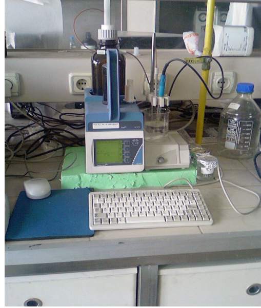
Resim 2.1. Sırasıyla Jasco FTIR 480 Plus cihazı ve Shott Alpha TA 50 Plus titrasyon cihazı
