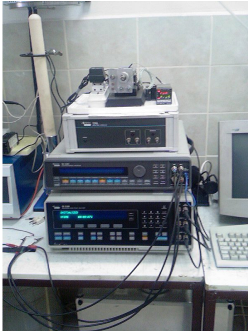
Resim 2.2. Aşağıdan yukarıya doğru Solartron 1260 Frekans Analizörü, Solartron 1287 EI Potansiyotat, Solartron 1296 Dielektrik arayüzü ve İletkenlik ölçüm hücresi
