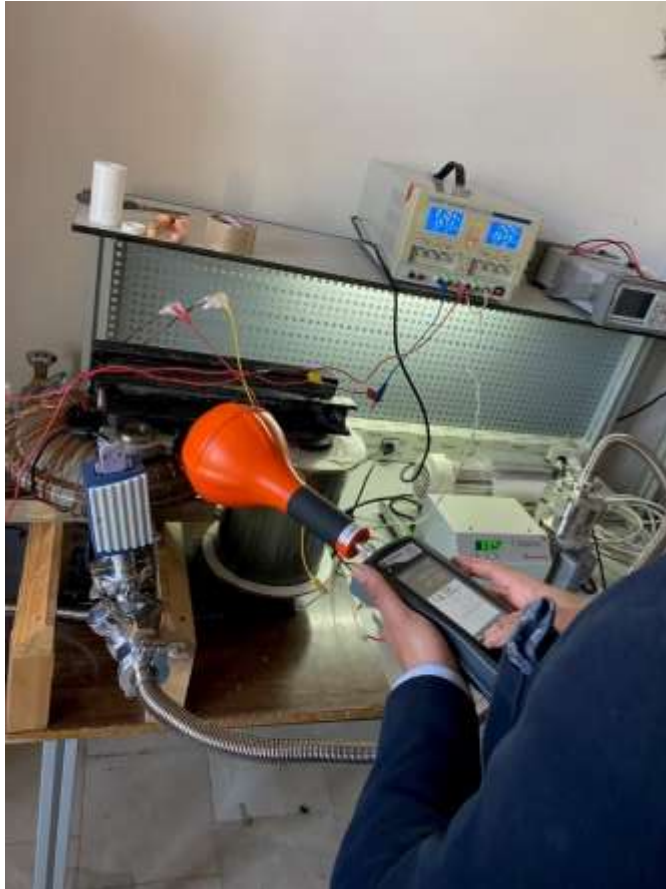
Şekil 4.20. Plazma sistemi çalışırken ekranlamasız yapılan ölçüm
