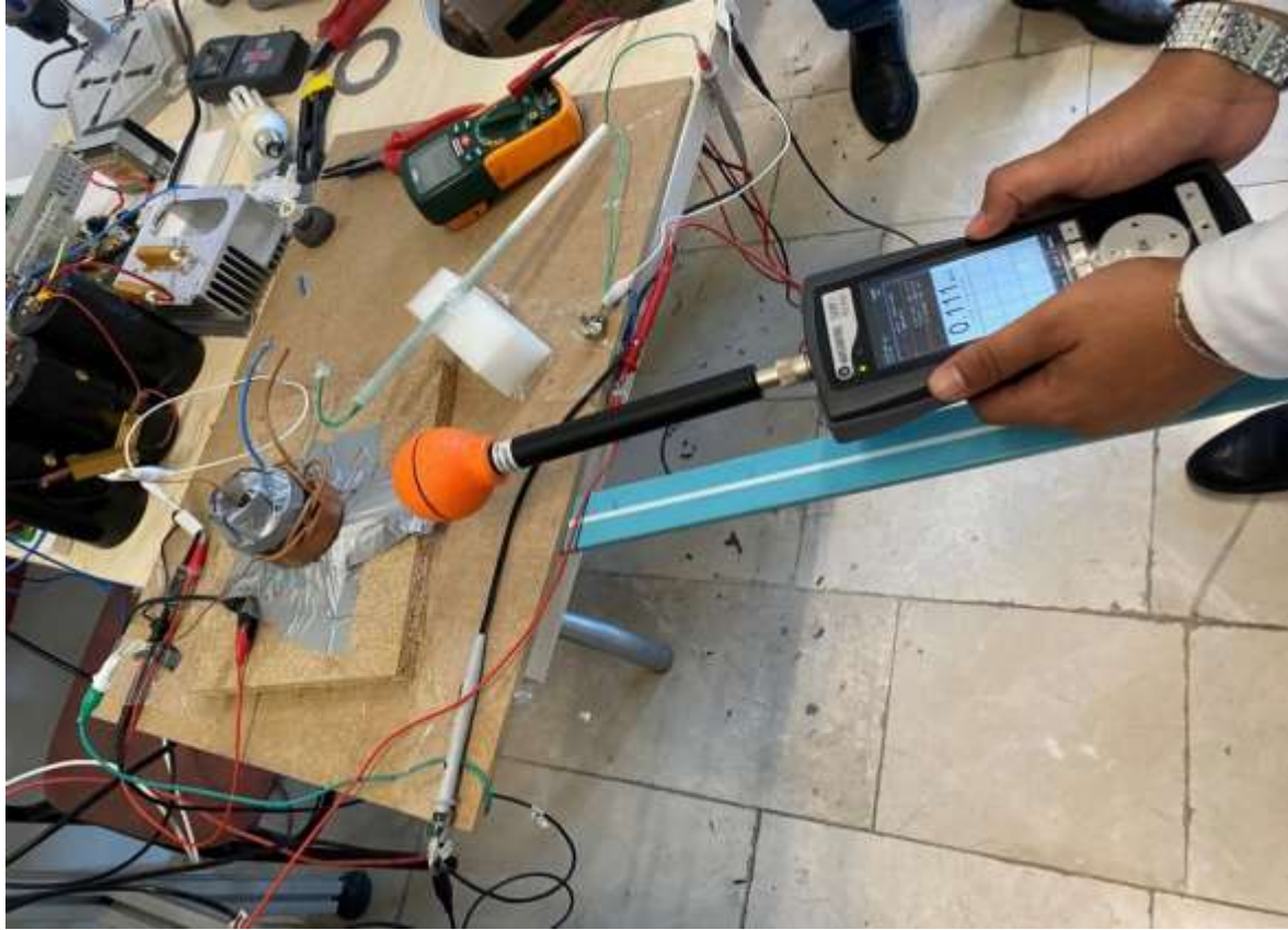
Şekil 4.12. Elektromanyetik alan ölçüm cihazı ile magnetron değerlerinin ölçümü
