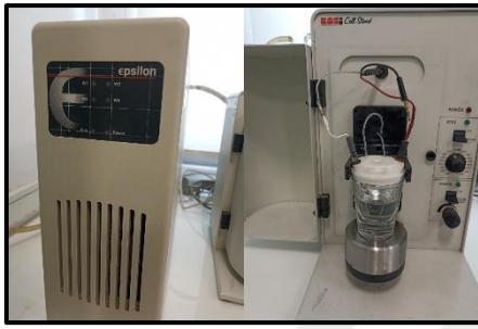
Resim 3.1. Epsilon model BAS marka elektrokimyasal analiz cihazı
