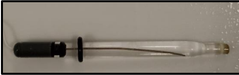
Resim 3.4. Ag/AgCl (3 M KCl) referans elektrot
