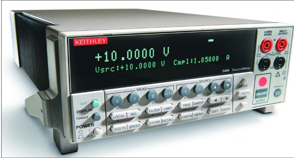
Resim 3.2. Keithley 2400 akım-gerilim kaynağı
