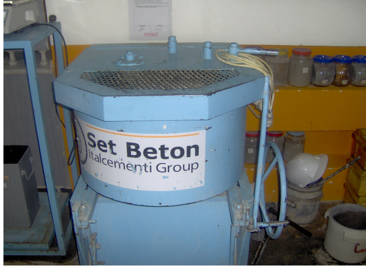
Resim 3.1. 75 dm 3 hacimli betoniyer
