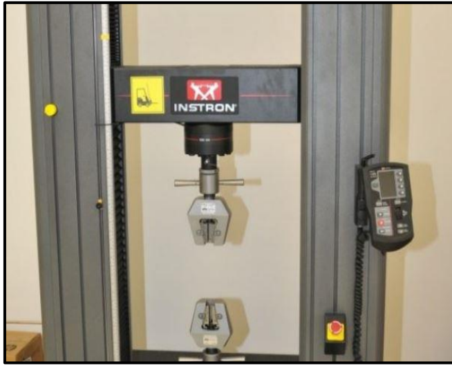
Resim 4.9. Instron marka 100kN çekme ve eğme test cihazı
