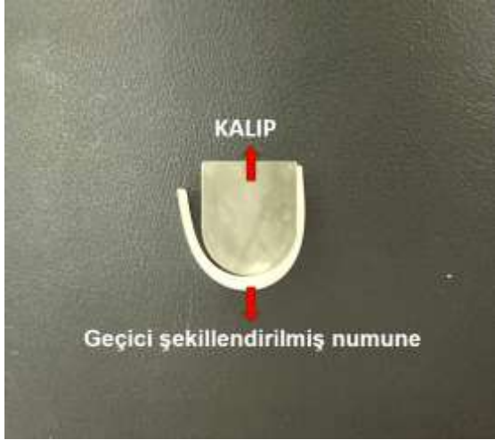
Şekil 3.11. 180 derecelik açıda geçici şekil hafızası verilen 0,35mm numune
