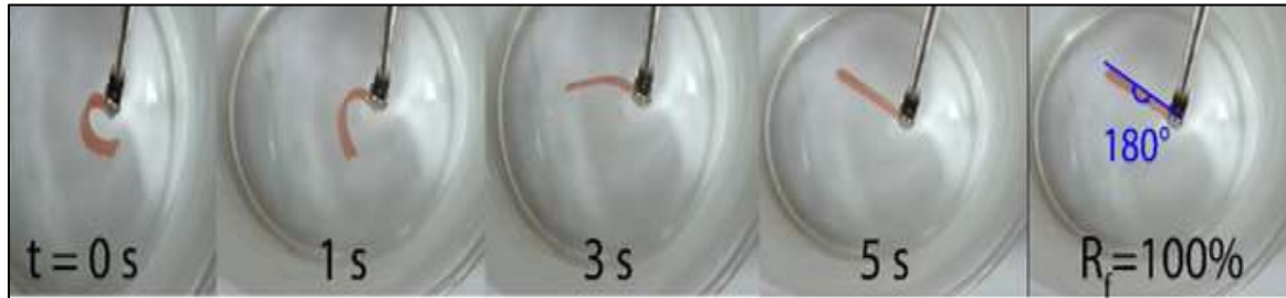
Şekil 2.9. PLA/PMMA Şekil değiştirme mekanizması [58]
