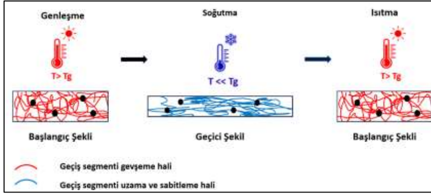
Şekil 2.4. Termal uyaranlı şekil hafızası etkisinin moleküler mekanizması [79]
