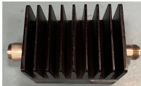
Şekil 6.1. Yansımaya ve iletim katsayısı ölçümünde kullanılan VNA (a) ve zayıflatıcı (b)
