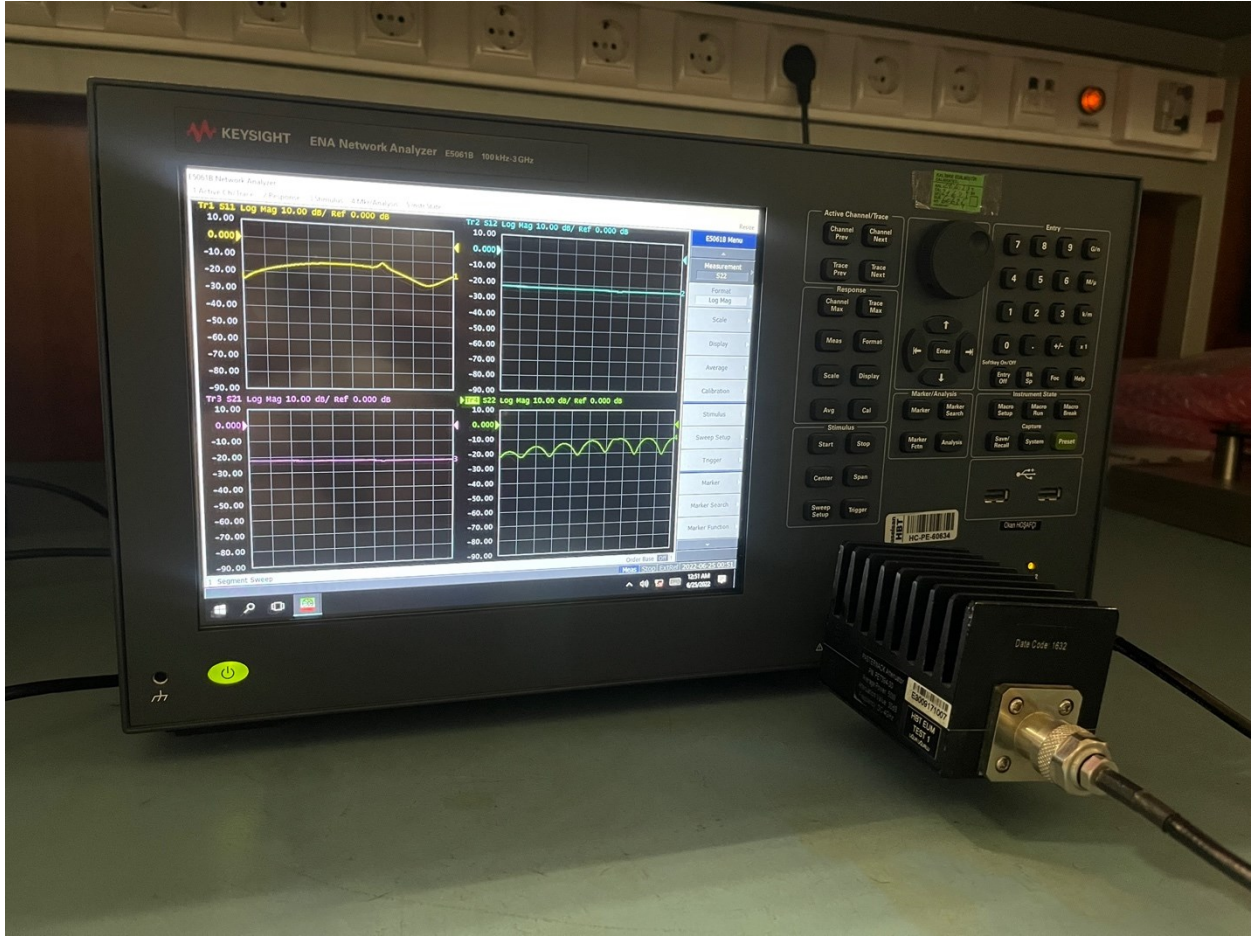
Şekil 6.4. VNA ile 30 dB zayıflatıcı ile yansımaya ve iletim katsayısı ölçüm düzeneği
