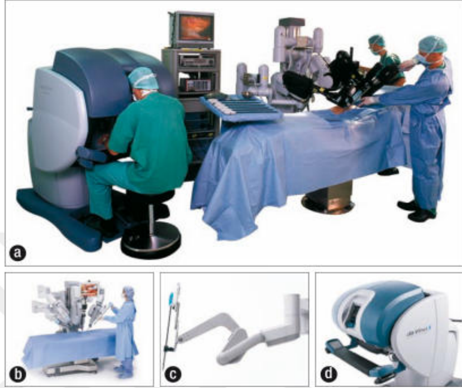
Resim 6. (a) Da Vinci cerrahi sistemi (b) Cerrahi saha kısmında laparoskopu ve cerrahi aletleri kontrol eden dört robotik kol (c) Robotik kollardan biri (d) Cerrah konsolu Photos courtesy of Intuitive Surgical, Inc.
