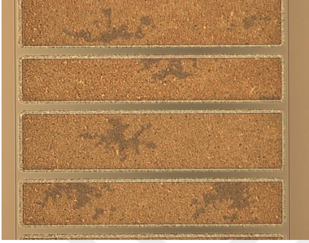
Resim 3.17. Via0 aşındırması sonrası transistör yüzey görüntüsü
