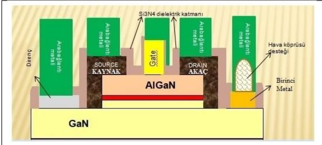
Şekil 3.9. Ara bağlantı metali sonrası MMIC üzerindeki gösterim
