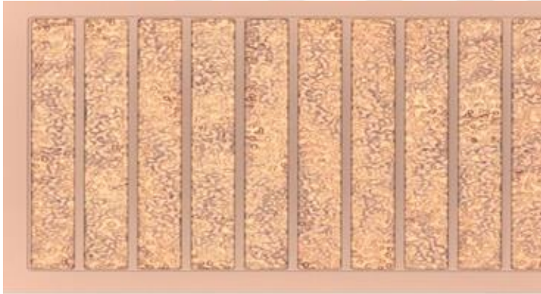
Resim 3.12. Aygıt adacığı aşındırma sonrası transistör optik mikroskop görüntüsü
