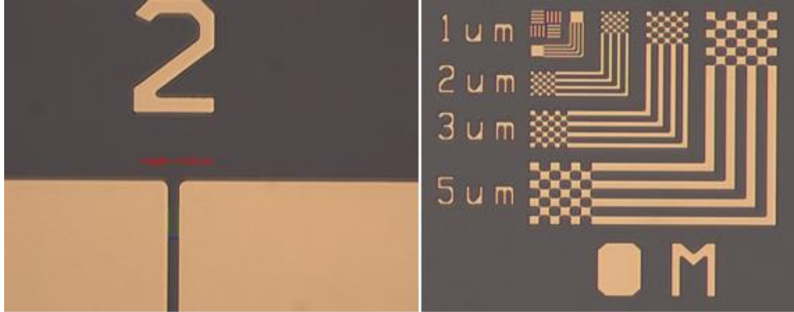
Resim 3.5. Omik metalizasyon işlemi sonrası kritik boyut ve çözünürlük desenlerinin mikroskop görüntüleri
