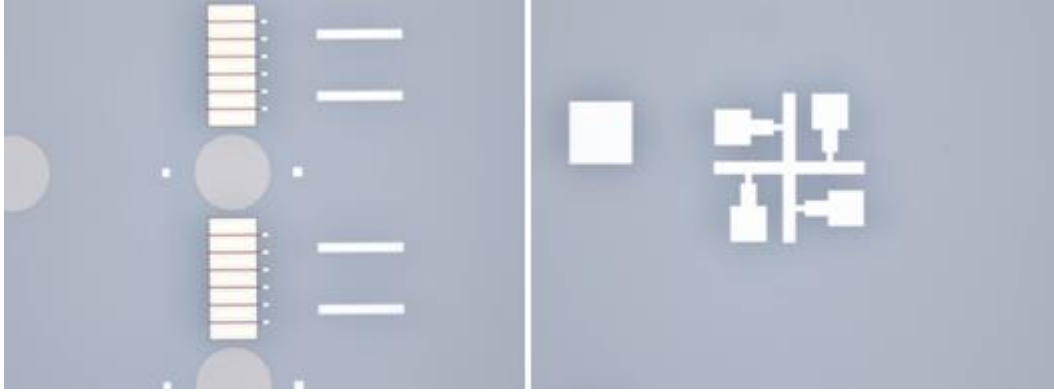
Resim 3.26. TFR kaplama sonrası rezistör desenleri ve ölçüm deseninin görünümü
