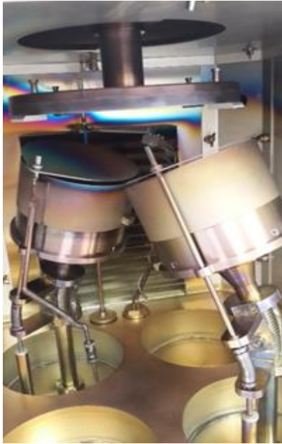
Resim 4.10. Vakum haznesi iç kısım örnek tutucular
