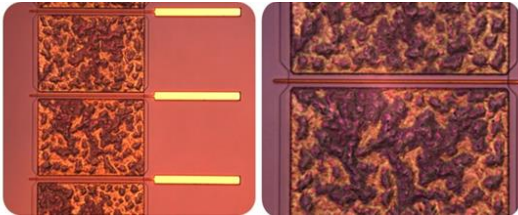
Resim 3.20. Kapı metalizasyon adımı sonrası transistörlerden alınan optik mikroskop görüntüleri
