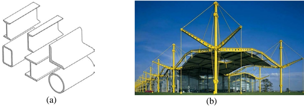
Resim 3.5. (a) Kesitlerine göre çelik yapı elemanları, (b) Spectrum building strüktür sisteminin görünümü (Macdonald, 2018).
