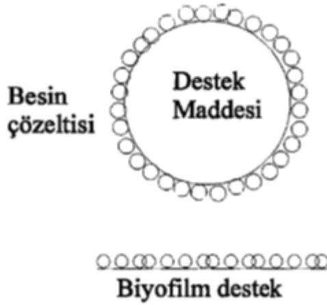
Şekil.2.17. Mikroorganizmanın yüzeye immobilizasyonu
