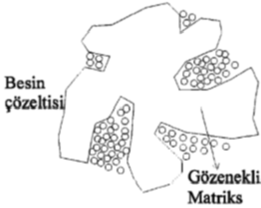
Şekil 2.18. Gözenekli matriks içinde mikroorganizma hapsedilmesi
