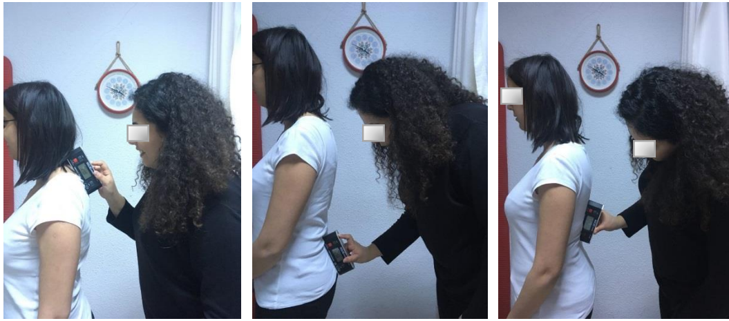
Resim 3.6. İnklinometre ile kifoz ve lordoz açılarının ölçümü
