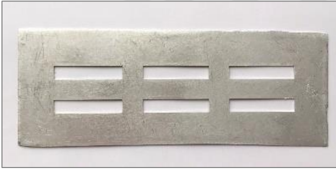
Resim 3.30. Çalışmada yırtılma direnci test örneklerini hazırlamada kullanılan 50 \times 10 \times 1 \text{ mm}^3 boyutlarındaki kalıp
