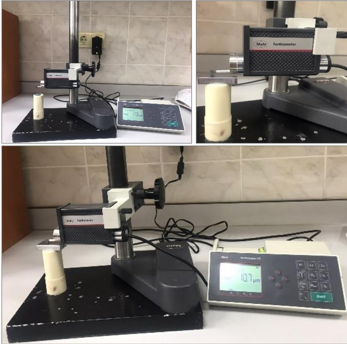
Resim 3.45. Çalışmada kullanılan portatif profilometre (Perthometer M2, Mahr GmbH, Göttingen, Almanya) ve kalibrasyon ölçüm örneği
