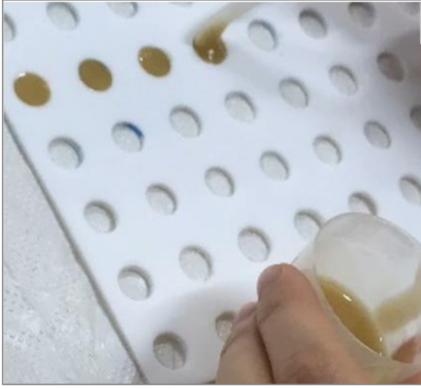
Resim 3.22. Deney örneklerinin hazırlanması için politetrafloroetilen kalıplara yerleştirilmesi
