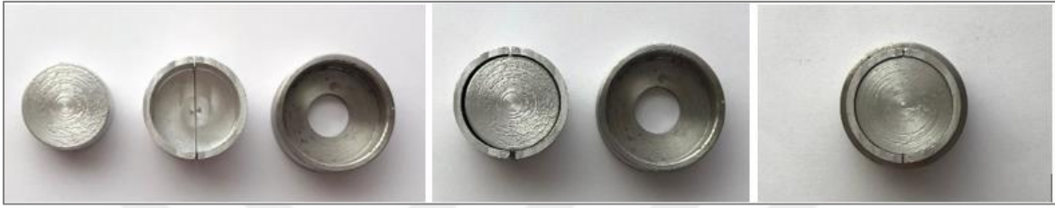
Resim 3.42. Yüzey pürüzlülüğü testi için kullanılan kalıbın yerleştirilme sırasına göre görünümü
