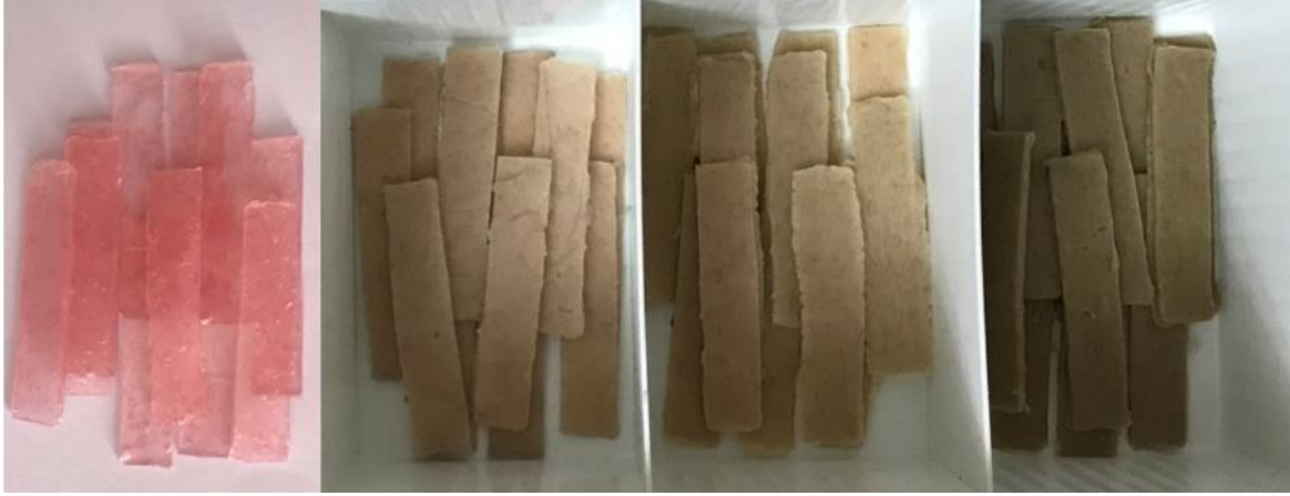
Resim 3.33. Yırtılma direnci testi için hazırlanan doku şartlandırıcı örnekler (sırasıyla kontrol, Thymus vulgaris , Salvia officinalis ve Mentha piperita )
