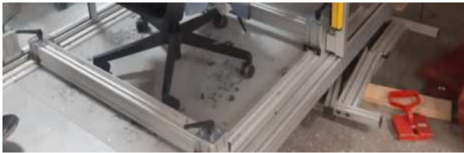
Resim 4.18. Koltuğun platforma tekerleklerden sabitlemesi
