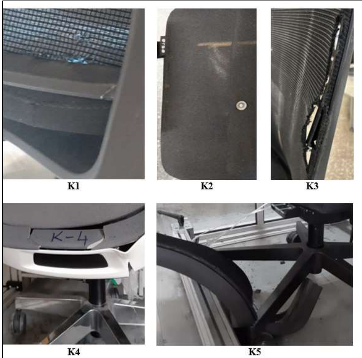
Resim 6.1. Deneyler sonunda koltuklarda meydana gelen hasarlar
