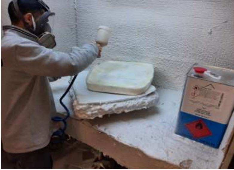
Resim 4.12. Poliüretan malzemeye yapıştırıcı uygulanması
