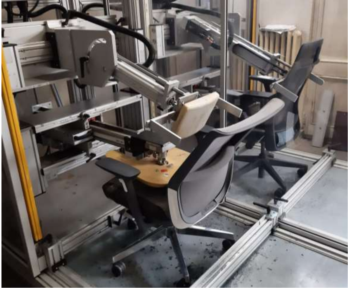
Resim 4.19. Servo motorlu yükleme pistonu ve başlığı
