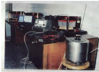
Resim 2. ELF manyetik alan sistemini içeren Helmholtz bobin sistemi
