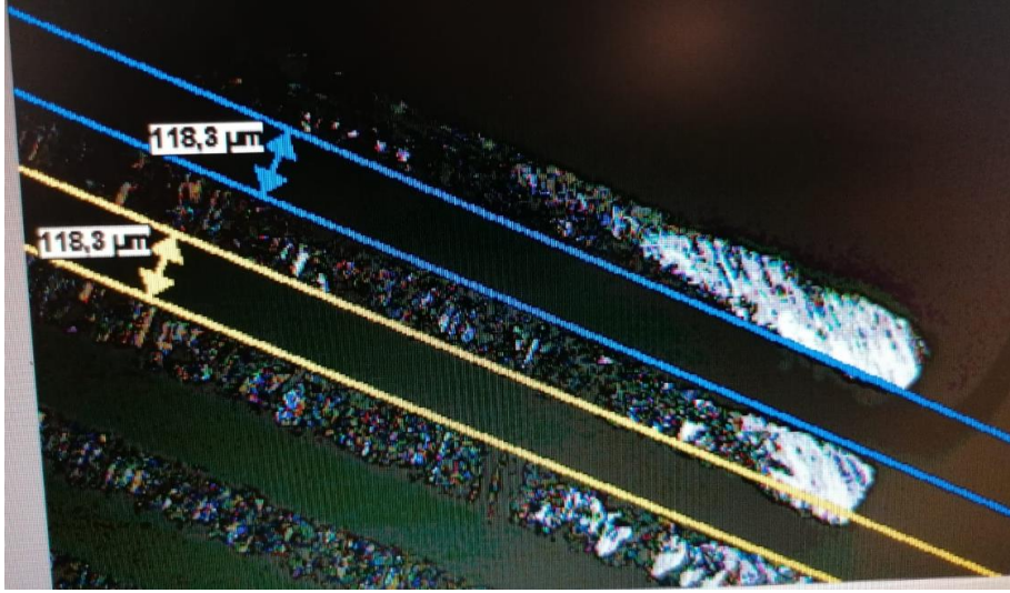
Şekil 6.5. Test edilen ürüne ait mikroskop altında ölçülen kanal genişlikleri. Ortalama kanatçık aralığı 118 \mu\text{m} gelmektedir (Clemex Vision)
