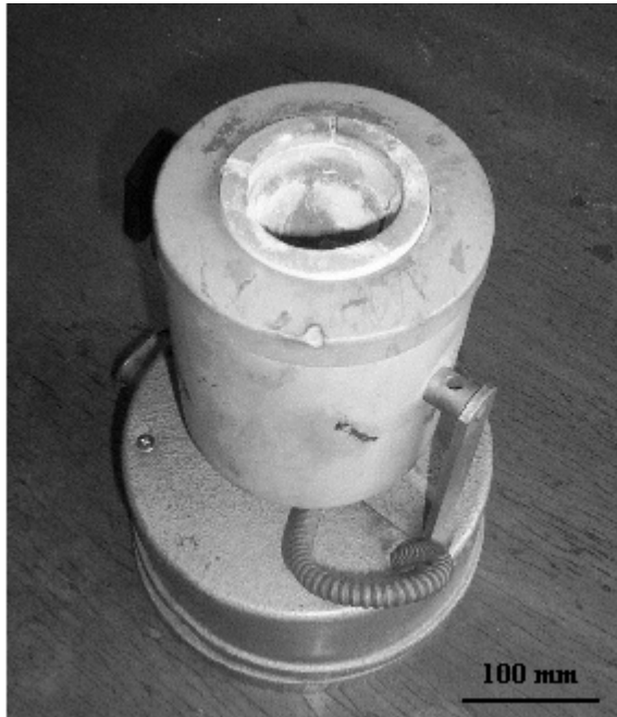
Resim 6.2. Deneylerde kullanılan ergitme ocağı
