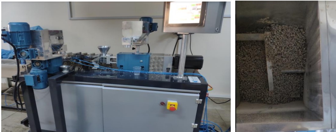
Şekil 4.5. Polmak Plastik çift vidalı ekstrüder makinesi ile üretim
