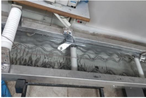
Şekil 4.6. 3 mm çapında tel elde edilmesi işlemi
