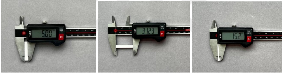
Resim 3.4. Örnek boyutlarının dijital kumpas ile ölçülmesi
