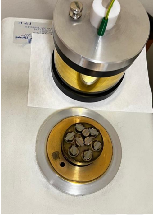
Resim 3.15. Altın kaplama cihazı ve altınla kaplanan örnekler
