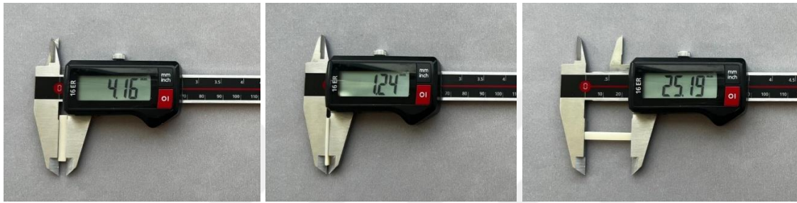
Resim 3.7. Sinterleme sonrası örnek boyutlarının kontrol edilmesi
