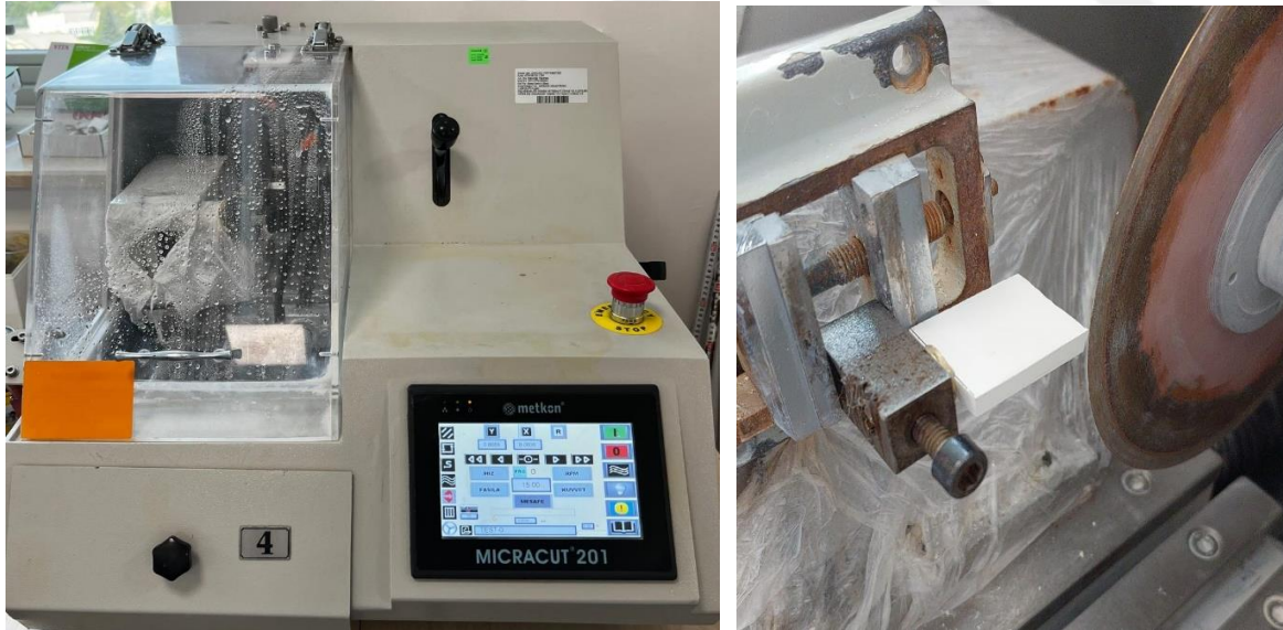
Resim 3.2. Hassas kesit alma cihazı ile örneklerin elde edilmesi
