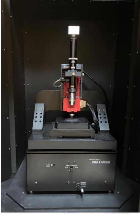
Resim 3.14. Yüzey pürüzlülüğünün değerlendirildiği atomik kuvvet mikroskobu
