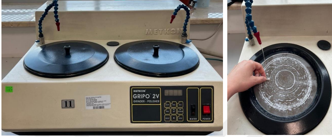
Resim 3.3. Zımpara cihazı ve örneklerin su altında zımparalanması
