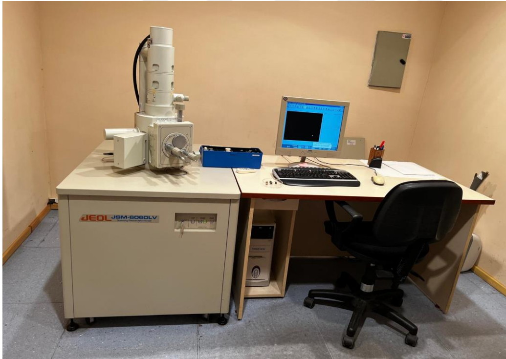
Resim 3.16. Yüzey incelemesinde kullanılan taramalı elektron mikroskobu
