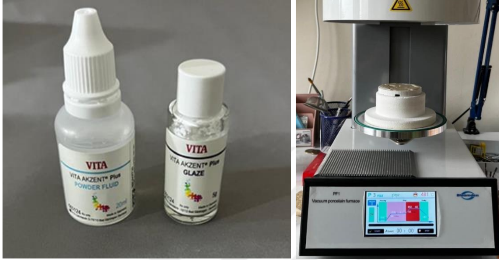
Resim 3.9. Glaze işleminde kullanılan toz, likit ve porselen fırını
