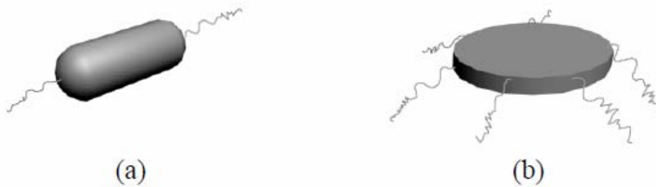
Şekil 2.7. Kalamitik/Çubuksu (a) ve disk biçimli (b) SK'lerin biçimleri
