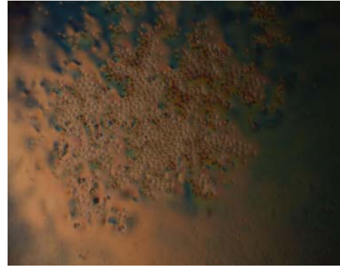
Resim 4.2. Nematik-izotropik faz geçişi sırasında E63 sıvı kristaline ait tekstürler
