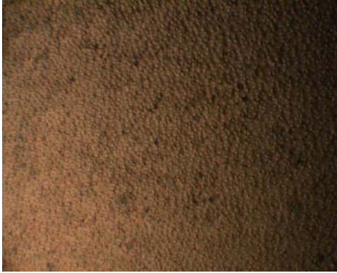
Resim 4.2. Nematik-izotropik faz geçişi sırasında E63 sıvı kristaline ait tekstürler
