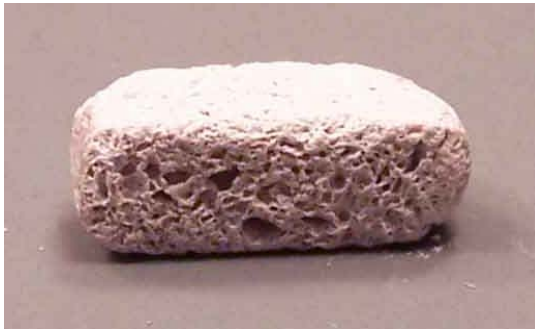
Resim 3.4. Gözenekli yapı haline getirilmiş pellet
