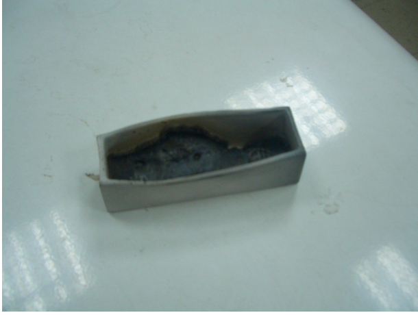
Resim 4.6. Argon atmosferinde 2 saat bekletilen ve süre fazla geldiğinden dolayı alumina pota içine erimiş malzemenin fotoğrafı
