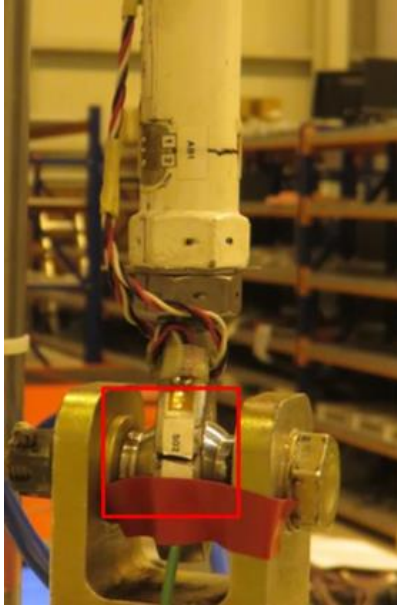
Resim 4.3. Numune 1 çubuk ucu arızası
