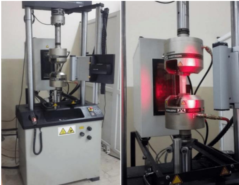
Resim 4.2. Test set up deney cihazı instron 8801 [24]
