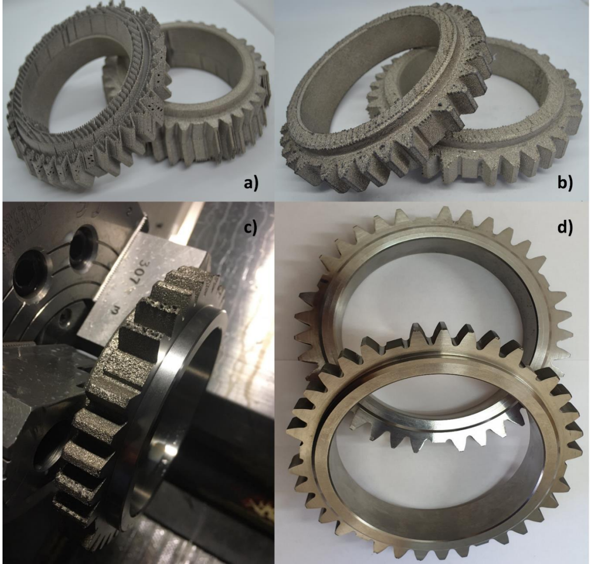
Resim 3.4. Dişli parçanın son haline getirilmesi: a) EBM üretimi sonrası dişli parça; b) Destek kısımları çıkarılmış dişli parça; c) Tornalama işlemi sonrası dişli parça; d) Tel erozyon işlemi sonrası dişli parça.
