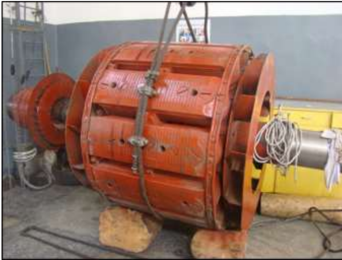
Resim 2.4. Çıkık kutuplu senkron generatöre ait rotor örneği
