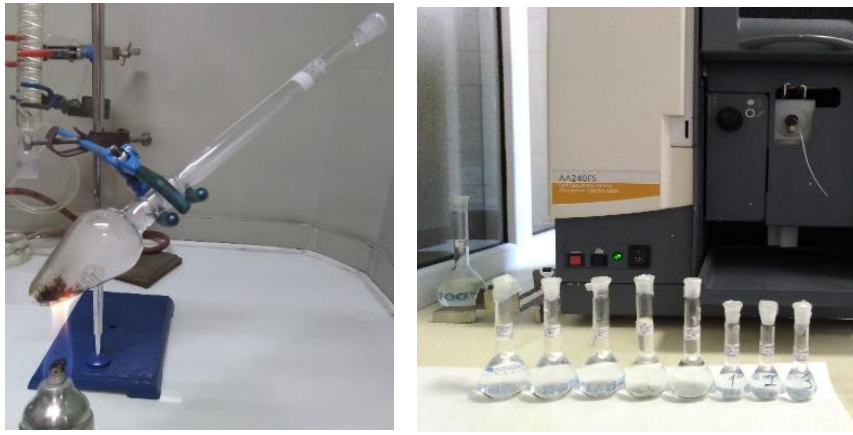
Resim 3.1. Atomik absorpsiyon spektrofotometrisi cihazının, hazırlanan standartlar ve örneklerin görüntüsü
